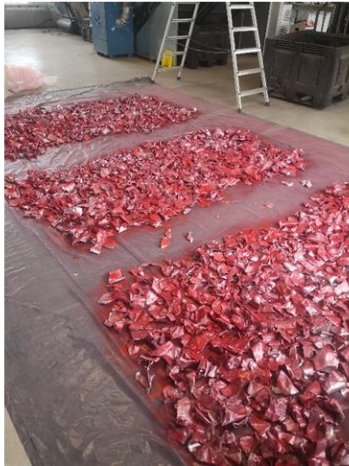
Abbildung 8: (links) markierte Testcharge aus definiertem Material; (rechts) Materialfraktionen nach der Sortierung (rot markiertes Material sollte aussortiert werden)
