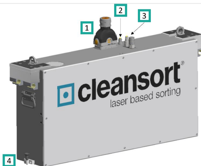
Abbildung 10: Weiterentwickeltes clean2sort-Modul inkl. „Plug & Play“-Anschlüssen für 1) Informationsaustausch & Spannungsversorgung, 2) Sperrluftanschluss, 3) Vor- und Rücklauf Kühlmedium, 4) Arretierbolzen
