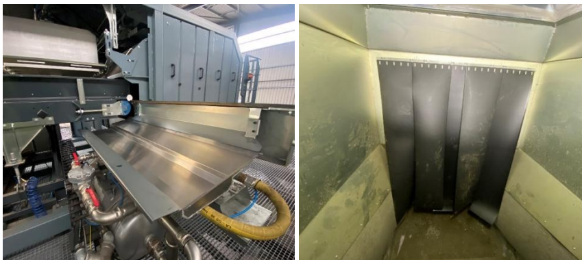
Abbildung 7: (links) Nachgerüstete ausziehbare Fangschale für Kleinstpartikel und Anhaftungen; (rechts) Nachgerüstete Abhängung im Bereich der Schwingförderrinne
