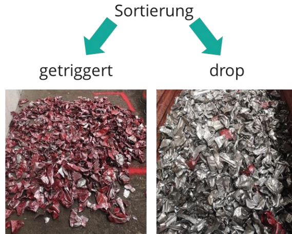
Abbildung 8: (links) markierte Testcharge aus definiertem Material; (rechts) Materialfraktionen nach der Sortierung (rot markiertes Material sollte aussortiert werden)
