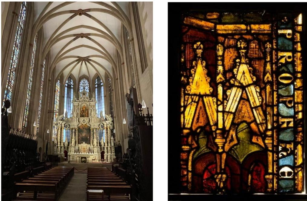
Abbildung 4: Links: Blick in den Hohen Chor mit den mittelalterlichen Glasmalereien, wobei Fenster süd II und nord II ausgebaut sind und farblos/grau erscheinen. Rechts: mittelalterliches, stark korrodiertes Glasmalereifeld des Fensters nord II, Feld 6 d, auf dem verschiedene ORMOCER®-Beschichtungsvarianten auf einzelnen Segmenten der Innen- und Außenseite aufgetragen wurden – bezeichnet als „Erfurt III“.
