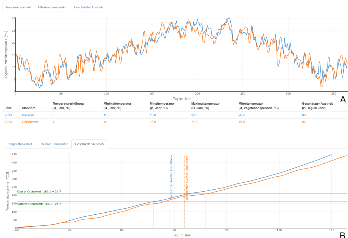
Abbildung 8: Beispiel für Temperaturverläufe in Marseille und Geisenheim für das Jahr 2023. Die Daten aus Marseille sind gemessene Daten, die für Geisenheim basieren ebenfalls auf gemessenen Daten, wurden aber um 4°C erhöht, um extreme Klimaänderungen abzubilden (A). In der Konsequenz sind die simulierten Austriebsdaten sehr ähnlich (B).
