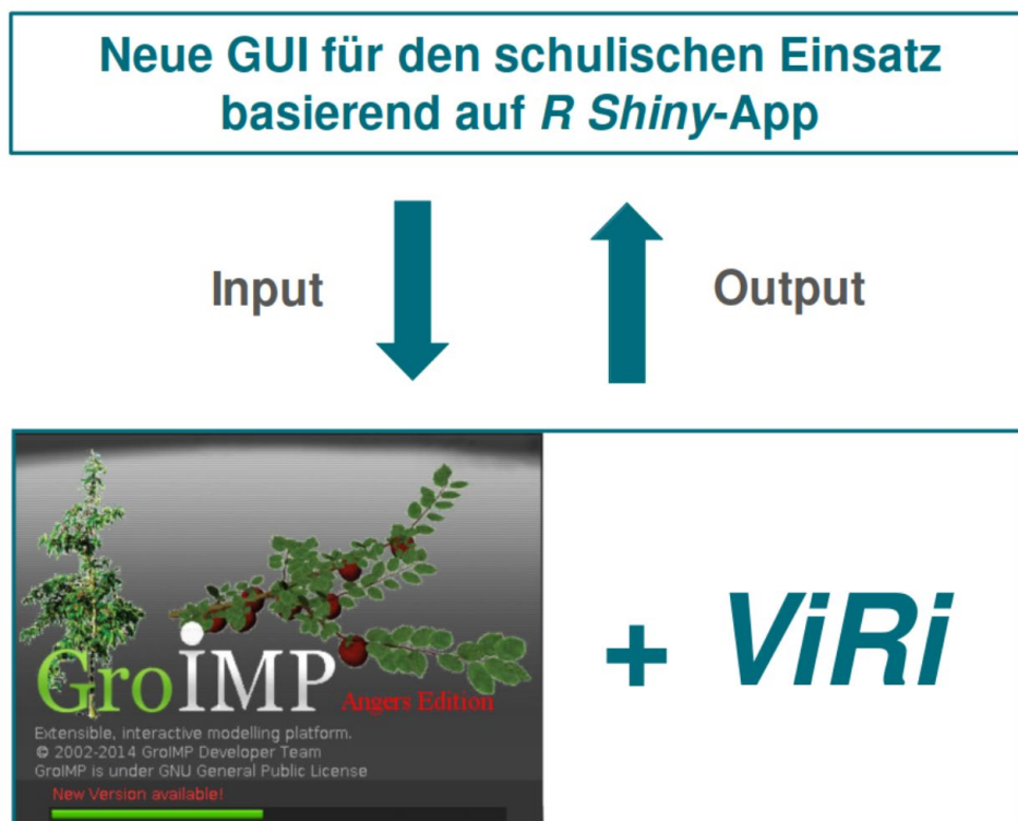
Abbildung 1: Workflow der neuen GUI in Kombination mit der Simulationssoftware „GroIMP“. Übergabe der Eingabe-Parameter (Input) der vereinfachten GUI an die Simulationssoftware GroIMP sowie Import der erzeugten Simulations-Ausgabe (Output) für die Darstellung der Simulationsergebnisse von dem Modell Virtueller Riesling (ViRi) durch die GUI.
