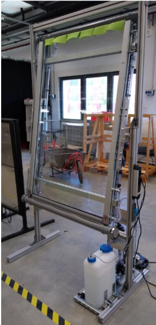
(a) Messaufbau Verdunstungsfläche mit Pumpe und Vorratsbehältnis. (b) Detailansicht der Benetzung.
