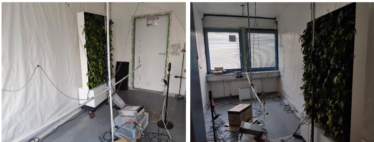
Abbildung 24: Der Messraum der Zwillingräume mit der Living Wall Indoor.
