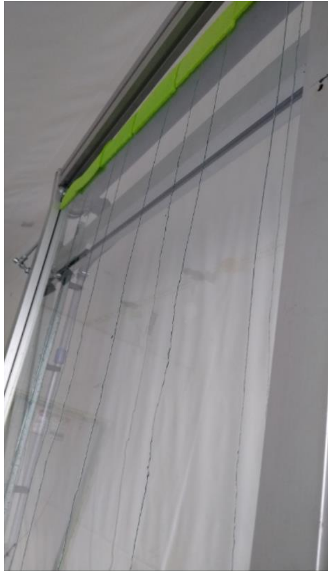
(a) Messaufbau Verdunstungsfläche mit Pumpe und Vorratsbehältnis. (b) Detailansicht der Benetzung.
