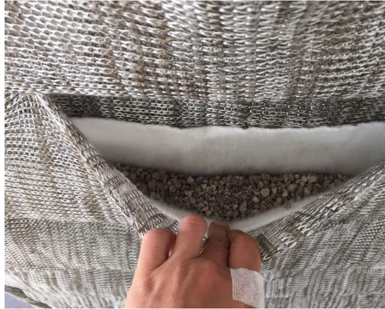
Abbildung 3: Vertiko-Spezial-Substrat „Indoor“ in Pflanztasche aus Vlies und Glas-Basaltgestrick
