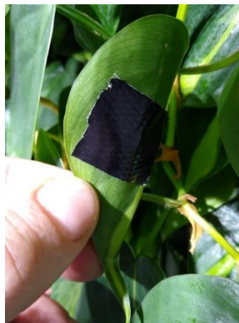
(b) Der Sensor wurde auf der Unterseite mit einem Streifen Gewebeklebeband gegen Verrutschen gesichert.
