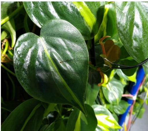
(a) Nach Durchstechen der Blattfläche mittels Nadel konnte der Temperatursensor von oben eingefädelt werden.
