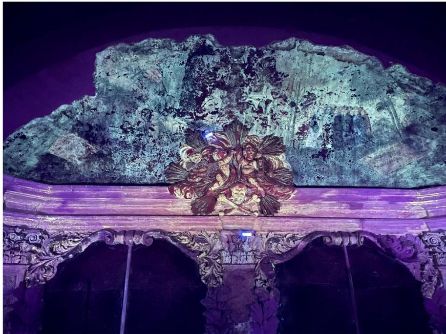
Abb. 4: UV-induzierte VIS-Lumineszenz (UV-Fluoreszenz) im oberen Bereich des Epitaphs mit der Wandmalerei, Fluoreszenzen deuten auf den Einsatz von Polymeren hin, dunkle Stellen in der Wandmalerei zeigen Retuschen an
