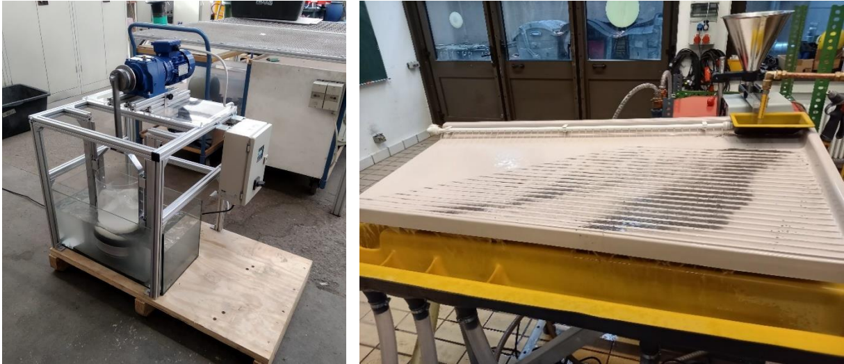
Abbildung 4: Setzversuche; links: selbstgebaute Setzmaschine; rechts: Setztisch bei der BAM
