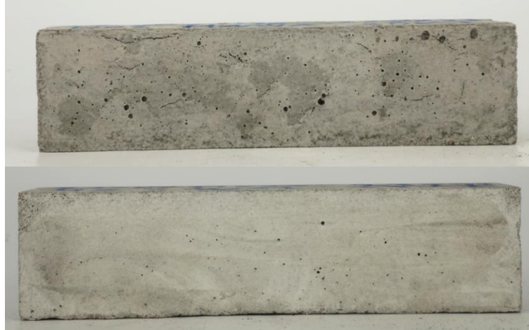
Abbildung 40: Prismen mit 40% des Zementes ersetzt durch HMVA (oben) und Quarzmehl W12 (unten). Bei dem HMVA-Prisma sind deutliche Risse zu erkennen. Maße: 16x4x4 cm.
