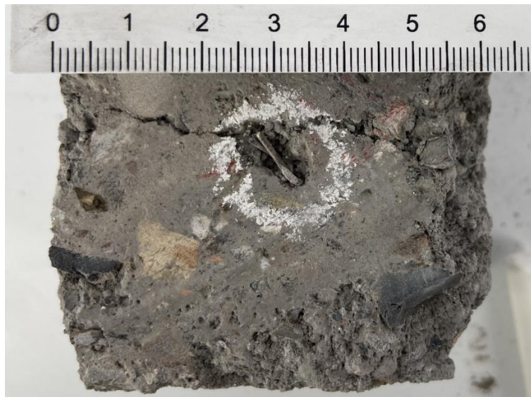
Abbildung 59: Metallstück bei der für den Abriebwiderstand nach Böhme vorbereiteten Probe der Mischung "gelb"
