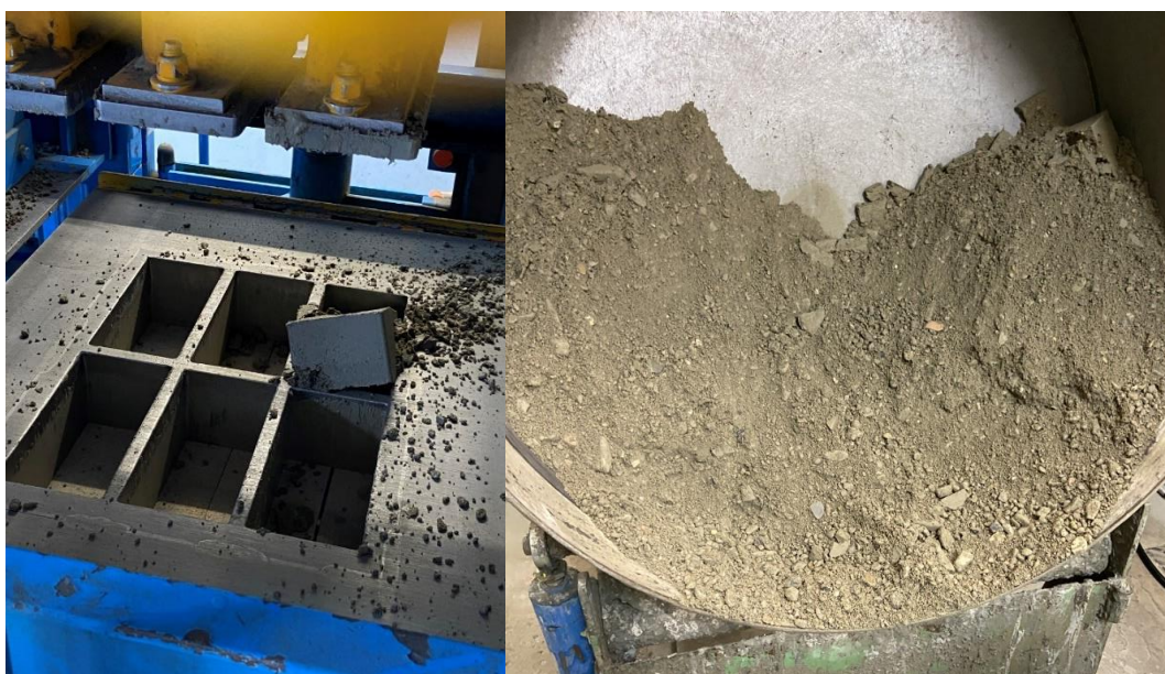
Abbildung 49: Herstellung von Pflastersteinen im Technikumsmaßstab. Links: "Stempelkleber" durch eine zu feuchte Konsistenz. Rechts: erdfeuchte Konsistenz für eine optimale Herstellung.
