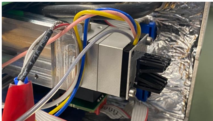
Abbildung 15: LED-Platine mit Kühlkörper
