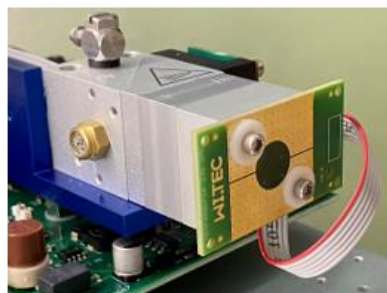
Abbildung 30: Modell des neuen Linsen-Adapters
