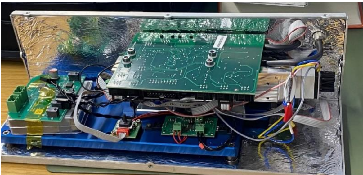
Abbildung 7: Modul 19446 in der geöffneten Thermobox durch LED-Lichtquelle ersetzt
