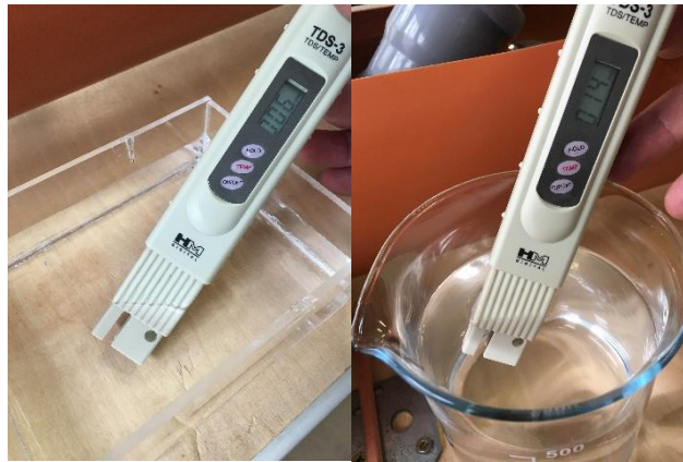
Abbildung 14: Links sieht man verdunstetes, gereinigtes Wasser aus der TAO-Versuchsanlage mit 6 ppm; rechtes Foto zeigt destilliertes Wasser (aus dem „Bauhaus“) mit 14 ppm.
