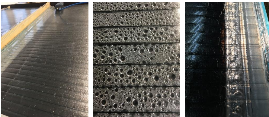
Abbildung 13: Die kleine Kondensationsstrecke, gebildet aus Glasstegplatten mit Luftdurchströmung
