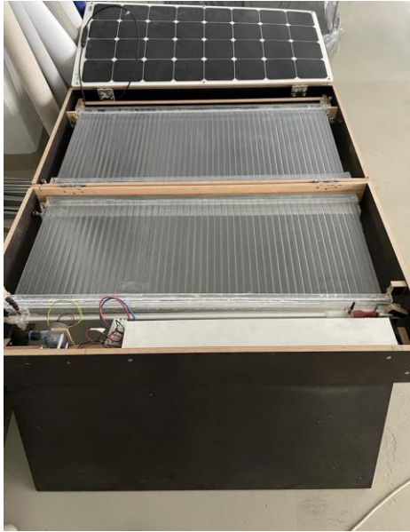
Abbildung 12: Das Solarpanel diente zur Energiegewinnung für eine kleine Luftpumpe, um die Durchspülung bzw. die Kondensation innerhalb des Wasserreservoirs zu optimieren und zu beschleunigen.
