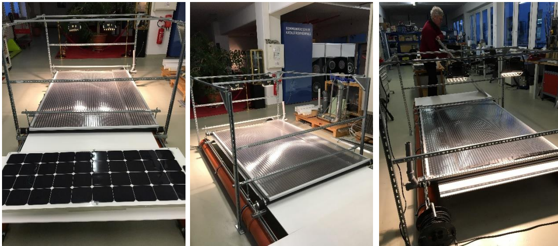
Abbildung 17: Ein größerer Versuchsträger mit einem Schwimmponton (für den Einsatz auf dem Wasser) wurde daraufhin konzipiert und gebaut. Mangels solarer Sonneneinstrahlung wurden für diesen großen Versuchsträger innerhalb der Versuchshalle sogenannte Baustrahler als Ersatz für das Sonnenlicht verwendet.
