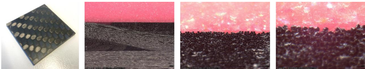
Abbildung 13: Foto der Oberfläche (links) sowie Mikroskopbilder des Querschliffs (rechts) des CFK-Materials Sigrapreg
