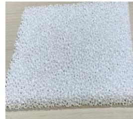
Abbildung 3: Schaumkeramik aus  $\text{Al}_2\text{O}_3$
