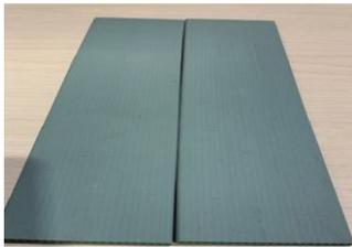
Abbildung 2: Mehrkanal-SiC-Keramik
