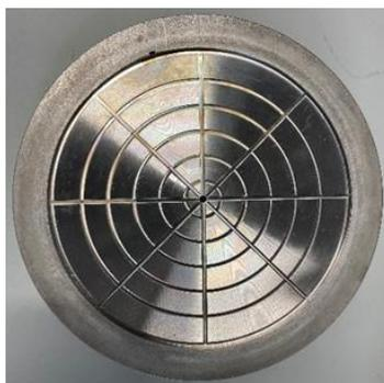
Abbildung 8: Boden mit eingefrästen Ablaufrinnen und Ablauf im Zentrum zum Sammeln des Permeats
