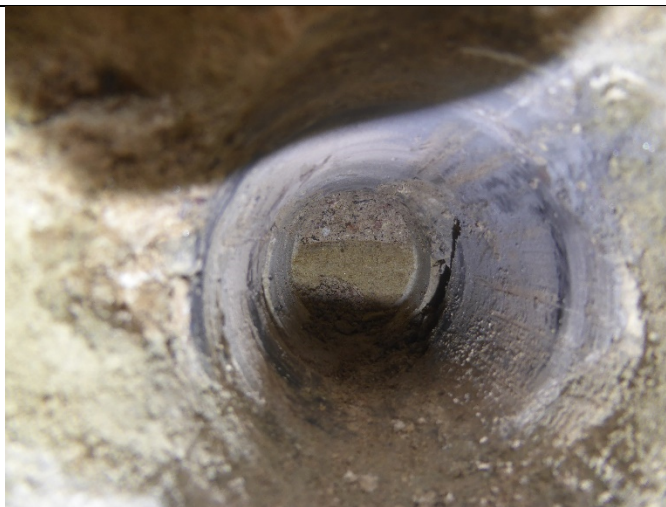
Abbildung 5: Kernbohrung WST/B/02, Bohrlochstirn nach Entnahme der Teilprobe WST/B/02.5 in 20 cm Bohrtiefe
