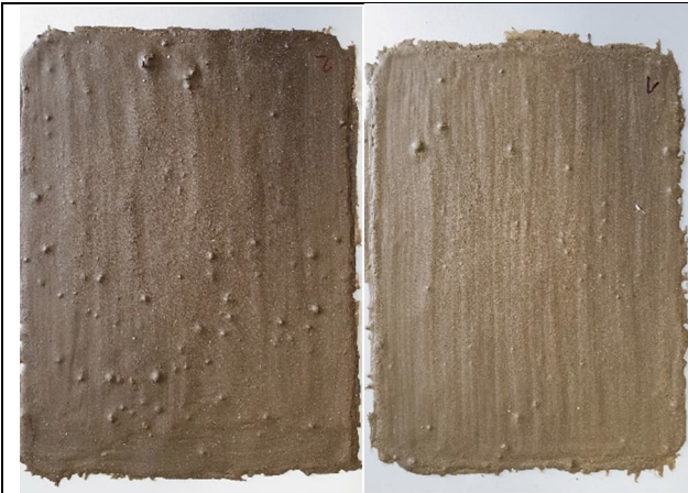
Abbildung 38: Dichtmaterialien für die Prüfung in der DMA, links Bitumenacrylat WEBAC 5611, rechts die bitumenfreie Variante („WEBAC 5611 weiß“), jeweils mit Füllstoff HSV-p 00 versehen
