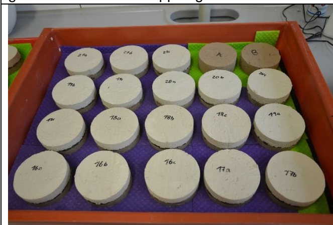
Abbildung 31: Versuchsanordnung für die Bestimmung der Wasseraufnahme durch kapillares Saugen. Oben rechts in der Schale liegen zwei Vergleichsprüfkörper ohne mittige Dicht- und Entkopplungsschicht.
