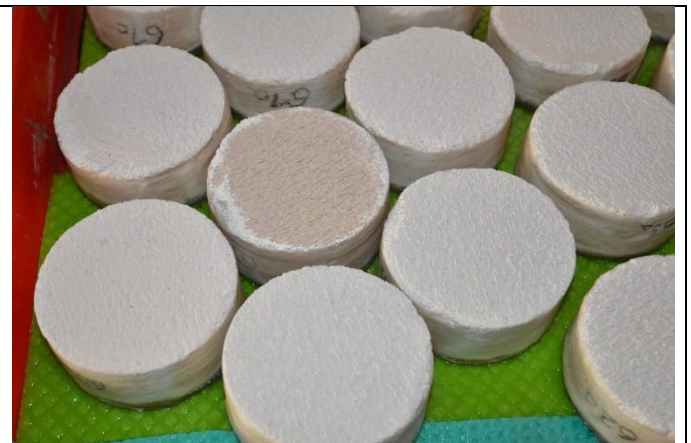
Abbildung 36: Prüfkörper während der Untersuchung zum Wasseraufnahmeverhalten. Die Porenbetonscheibe in Bildmitte weist einen Durchbruch der Abdichtungsschicht auf.
