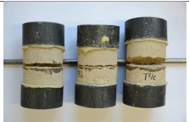
Abbildung 43: Verbundprüfkörper nach den Haftzugfestigkeitsprüfungen
