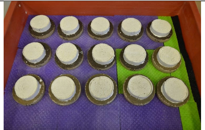
Abbildung 57: Verbundprüfkörper während der Untersuchungen zur Salzmigration: Die Salzlösung wird über die unteren Mörtelscheiben aufgenommen.
