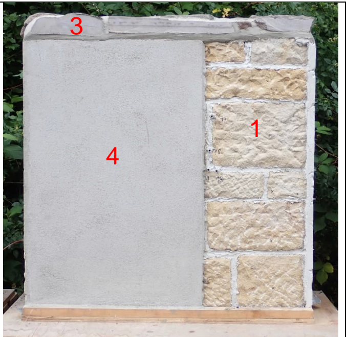
Abbildung 72: Mauerwerksdemonstrator, Sandsteinmauerwerk, vor der Außenbewitterung 1 ... Sandstein-Quadermauerwerk, gemauert mit Gipsmörtel 2 ... Hintermauerung mit Ziegelmauerwerk, Normalformat, gemauert mit Kalk-Zement-Mörtel, Entkopplung zum Sandstein-Mauerwerk durch WEBAC 5611 / tubag HSV-p 00
