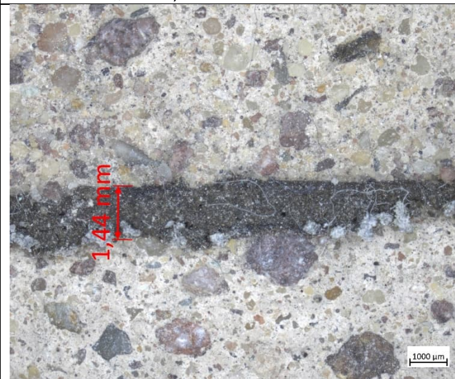
Abbildung 48: Verbundkörper C im Bereich der Dicht- und Entkopplungsschicht: Die Schichtdicke im Bildausschnitt ist vergleichsweise höher und liegt zwischen ca. 1 und 1,5 mm. Der Übergang von der Abdichtungsschicht zum aufliegenden Mörtel ist scharf abgegrenzt. (Bildunterkante: 12,1 mm)
