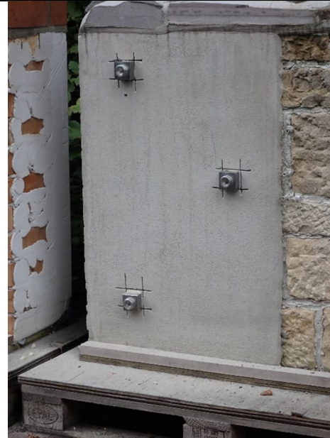
Abbildung 76: Putzfläche des Sandsteinmauerwerk-Demonstrators nach dem Aufsetzen der Prüfstempel für die Ermittlung der Haftzugfestigkeiten
