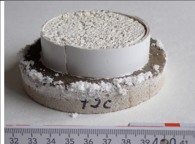
Abbildung 58: Verbundprüfkörper nach 120 Tagen Lagerung über der Salzlösung
