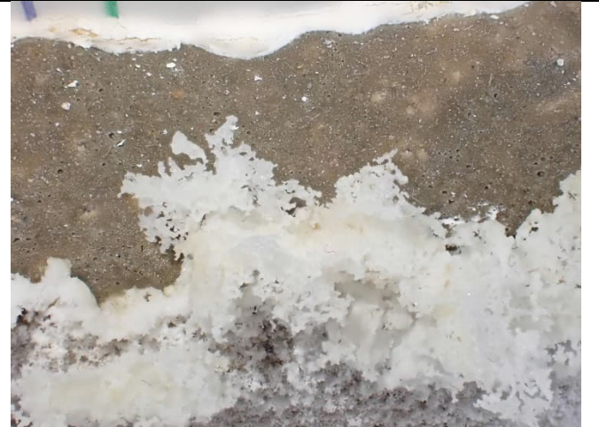
Abbildung 59: Detail der Abdichtungsoberfläche über der unteren Mörtelscheibe mit starken Salzauskristallisationen
