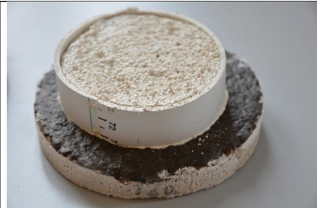
Abbildung 56: Verbundprüfkörper vor Beginn der Untersuchungen zur Salzmigration: Die untere Mörtelscheibe besteht aus einem hydraulischen Kalkmörtel, die obere, kleinere aus einem Luftkalkmörtel; dazwischen befindet sich die Abdichtungsschicht
