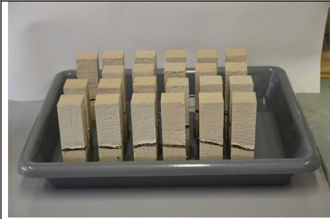
Abbildung 24: Gebrochene Mörtelprismen mit aufgetragener Dichtschicht auf den Bruchflächen
