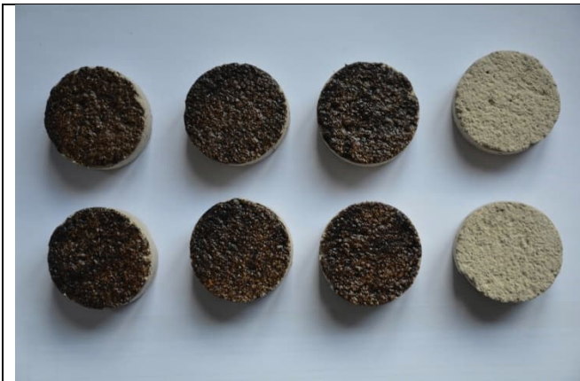
Abbildung 42: Prüfkörper während des Auftrages des Bitumenacrylat-Entkopplungssystems
