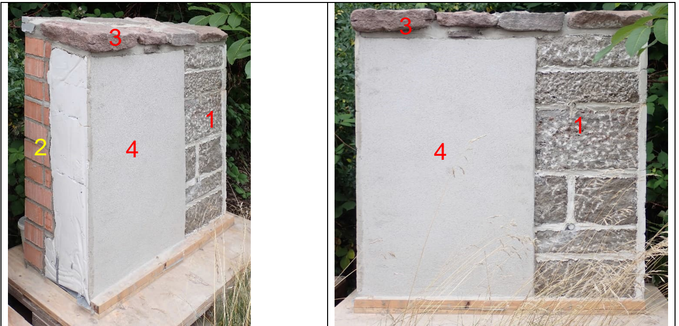
Abbildung 73: Mauerwerksdemonstrator, Kalksteinmauerwerk, vor der Außenbewitterung 1 ... Kalkstein-Quadermauerwerk, gemauert mit Gipsmörtel 2 ... Hintermauerung mit Ziegelmauerwerk, Normalformat, gemauert mit Kalk-Zement-Mörtel, Entkopplung zum Kalkstein-Mauerwerk durch WEBAC 5611 / tubag HSV-p 00 3 ... Aufmauerung Mauerkrone, Sandstein, gemauert mit Kalk-Zement-Mörtel, Entkopplung zum Kalkstein-Mauerwerk durch WEBAC 5611 / tubag HSV-p 00 4 ... Verputz auf Kalkstein-Mauerwerk, einlagig, hydraulischer Kalkputz, Entkopplung zum Kalkstein-Mauerwerk durch WEBAC 5611 weiß / tubag HSV-p 00
