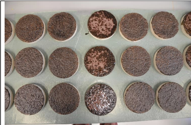
Abbildung 29: Mörtelscheiben mit frisch aufgetragener Dicht- und Entkopplungsschicht
