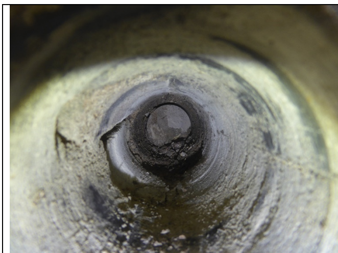
Abbildung 4: Kernbohrung WST/B/01, Bohrlochstirn nach Entnahme der Teilprobe WST/B/01.6 in 30 cm Bohrtiefe
