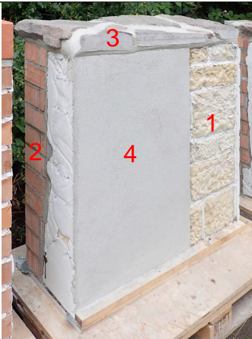
Abbildung 72: Mauerwerksdemonstrator, Sandsteinmauerwerk, vor der Außenbewitterung 1 ... Sandstein-Quadermauerwerk, gemauert mit Gipsmörtel 2 ... Hintermauerung mit Ziegelmauerwerk, Normalformat, gemauert mit Kalk-Zement-Mörtel, Entkopplung zum Sandstein-Mauerwerk durch WEBAC 5611 / tubag HSV-p 00
