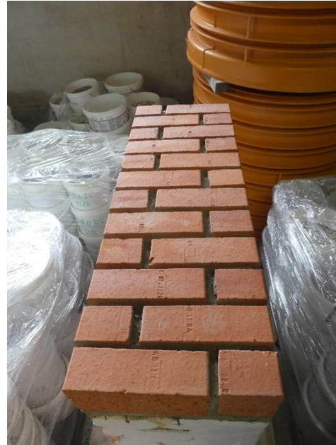
Abbildung 71: Mauerwerksdemonstrator, Ziegelmauerwerk mit aufgemauertem Klinker-Rollschicht über der Abdichtungsschicht, hier fehlt noch die Deckverfugung
