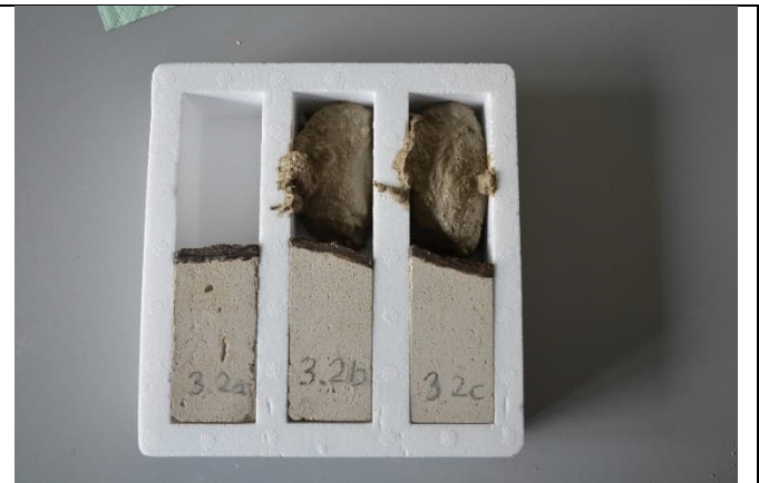
Abbildung 25: Einbringen des Mörtels über der Dichtschicht
