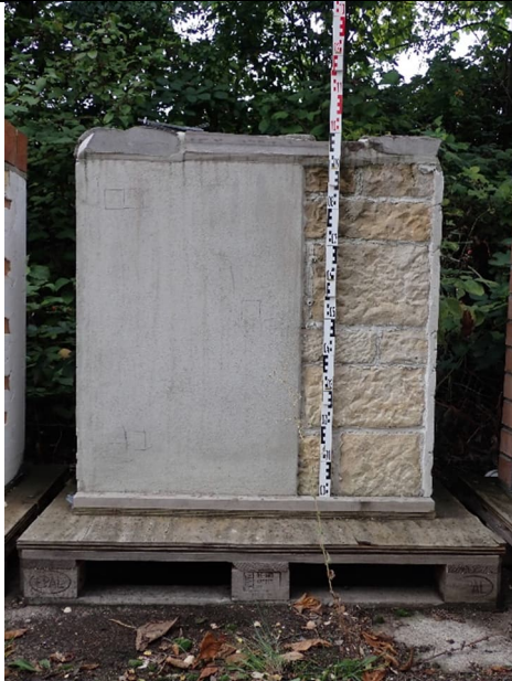
Abbildung 75: Demonstrator aus Sandsteinmauerwerk zum Zeitpunkt des Monitorings
