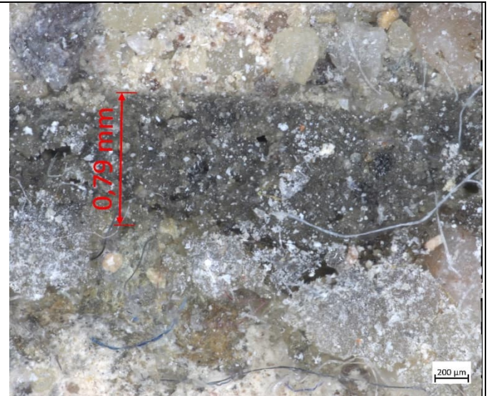
Abbildung 51: Verbundkörper D, vergrößerter Bildausschnitt mit erkennbarem Schichtenaufbau (Bildunterkante: 2,83 mm)
