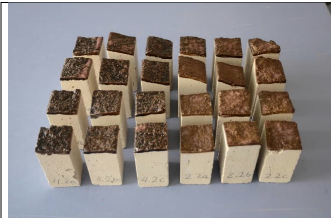
Abbildung 24: Gebrochene Mörtelprismen mit aufgetragener Dichtschicht auf den Bruchflächen
