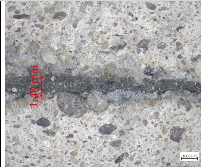
Abbildung 50: Verbundkörper D im Bereich der Dicht- und Entkopplungsschicht: Die Schichtdicke im Bildausschnitt ist vergleichbar mit A und beträgt zwischen 0,5 und 1,4 mm. Der Übergang von der Abdichtungsschicht zum aufliegenden Mörtel ist relativ scharf abgegrenzt. (Bildunterkante: 12,1 mm)
