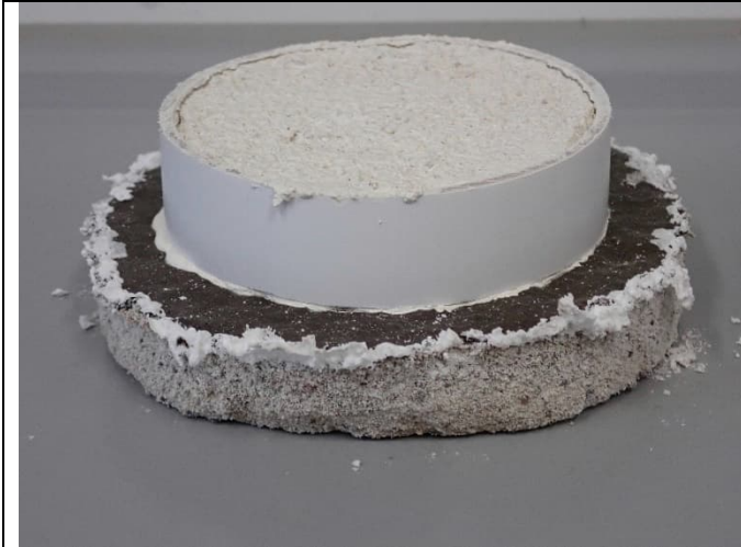
Abbildung 61: Verbundprüfkörper nach Abbruch der Untersuchungen zur Salzmigrations-Wechselbeanspruchung: Die untere Mörtelscheibe ist bereits extrem geschädigt, Salzränder haben sich am oberen Rand gebildet. Die Abdichtungs- und Entkopplungsschicht selbst ist indessen intakt.
