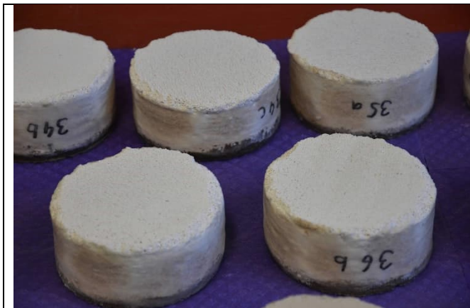
Abbildung 35: Porenbetonscheiben mit unterseitiger Abdichtungsschicht (= Saugfläche)
