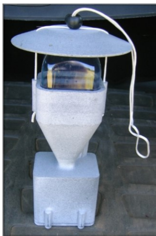
Abb. 19: Prototyp der digitalen Monitoringfalle mit Sonnen- bzw. Regenschutzdeckel
