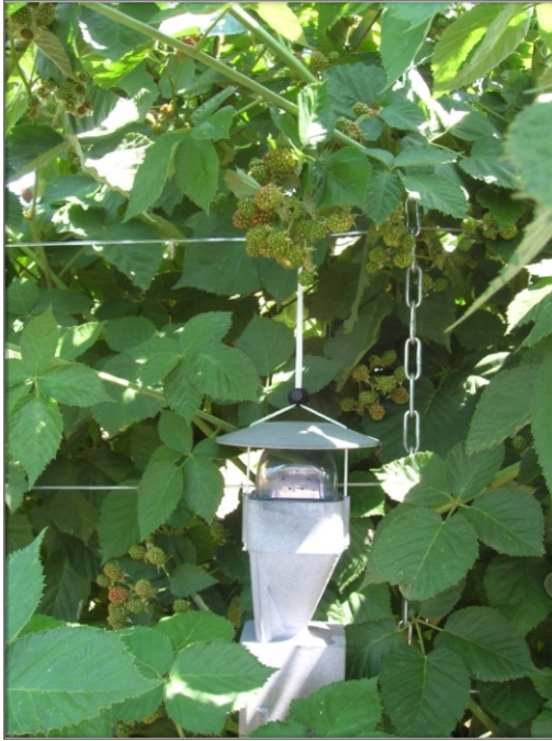
Abb. 21: Prototyp mit Sonnen-/ Regenhaube im Obstbau. Die Anbringung erfolgt über das Bindeband
