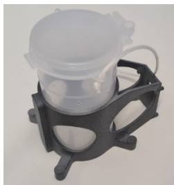
Fallenhalterung (Typ „grau“) aus Nylon mit ursprünglicher Köderfalle
