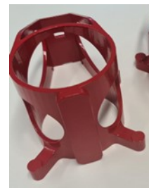
Altrahmen mit roter Lackierung für weitere Versuche (UV-Beständigkeit)
