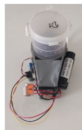
Fallenhalterung mit Fangbecher, Kameramodul, rechts sichtbare Batterien
