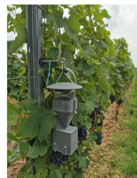
Prototyp im Freilandversuch mit Regenhaube und Magnetanbringung
