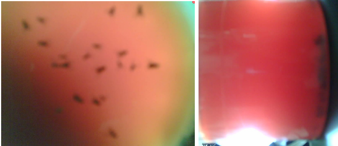
Abb. 8: Bildergebnisse der ersten Kameraanordnung des Prototyps 1 mit unscharfem Resultat. Links: in vermischten Zustand in der gesamten Flüssigkeit, rechts: am Behälterboden abgesetzt
