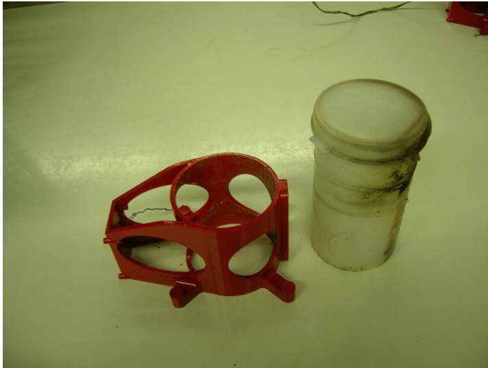
Abb. 25: lackierter Rahmen und ursprünglicher Fangbehälter nach 1,5 Jahren im Freiland: Altrahmen mit unbeschädigter roter Lackierung (links) daneben stark verschmutzte ursprüngliche Becherfalle; aktuell genutztes Fanggefäß mit nur leichten Vergilbungen (rechts).
