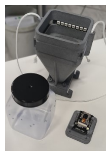
Modifizierte Falle mit LED am oberen Rand, Kameramodul unten, Fangdose und Batteriefach
