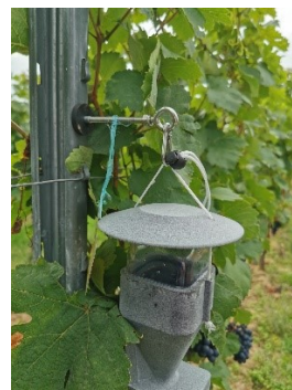
Sonnen- und Regenschutz und Magnetanbringung in Freilandtestung
