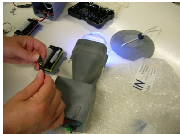
Abb. 18: Überprüfung der Funktionstüchtigkeit mittels eines Lichtsignals, hier: Funktionstest im Labor
