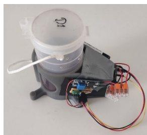
Nylon-Fallenrahmen mit Fangbecher und seitlichem Kameramodul
