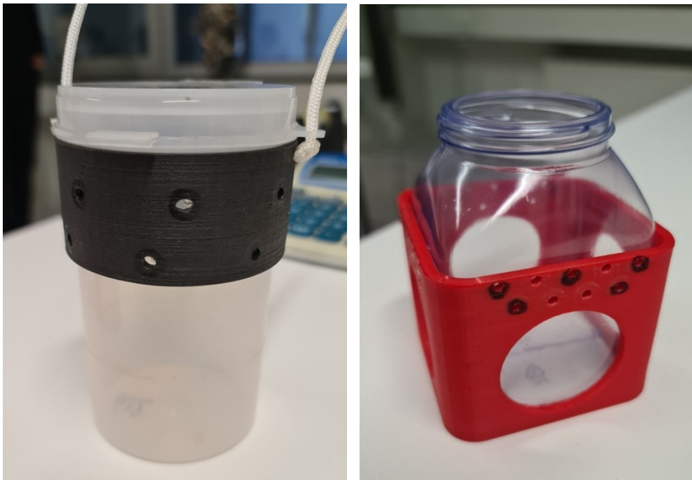
Abb. 10: Zwei Modelle mit unterschiedlichen Schablonen zur Bohrung der Einfluglöcher
