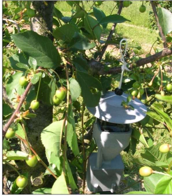
Abb. 21: Prototyp mit Sonnen-/ Regenhaube im Obstbau. Die Anbringung erfolgt über das Bindeband
