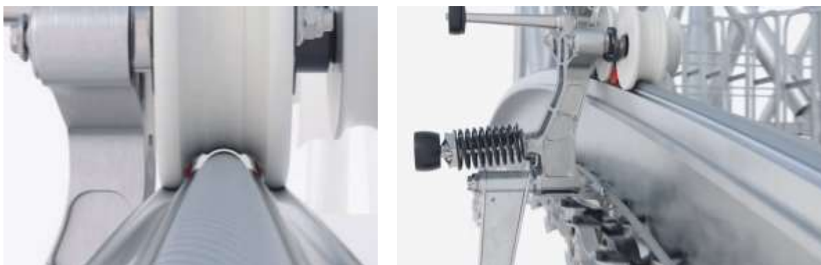
Abbildung 10.7: Stützenüberfahrt mit Laufschiene und speziellem Laufwerk [Lei04]
