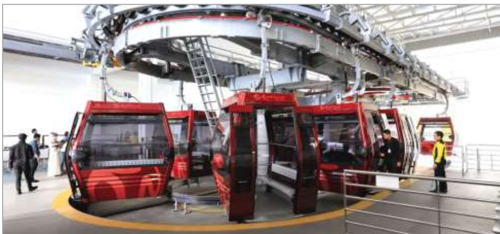
Abbildung 3.3: Ein- und Ausstiegsbereich einer Einseilumlaufbahn mit Kabinenführung und Reifenförderer [Lei03]
