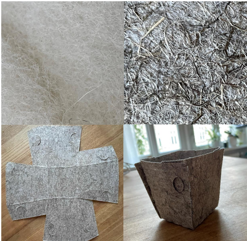
Abbildung 3: Vom Rohstoff Wolle (links oben) und Hanf (rechts oben) zum fertigen Produkt
