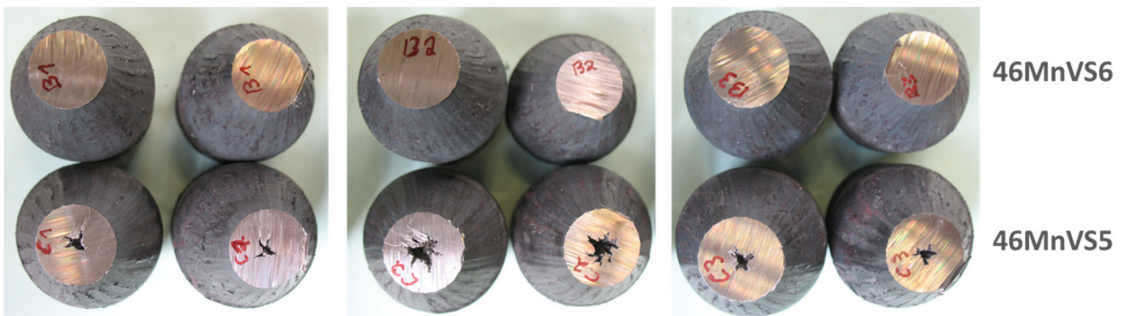
Bild 9: Gegenüberstellung von Walzergebnissen (mit identischen Prozess- und Walzparametern) mit dem alternativen Werkstoff 46MnVS6 und dem bisher verwendeten Werkstoff (46MnVS5)
