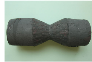
Vorform gewalzt (Werkzeug aus dem Vorprojekt)
