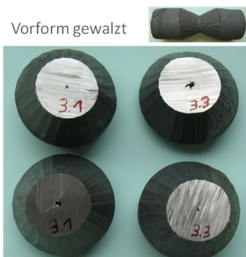
Bild 12: Gegenüberstellung von Walzergebnissen (mit identischen Prozess- und Walzparametern) mit gewalzten und gedrehten Vorformen.
