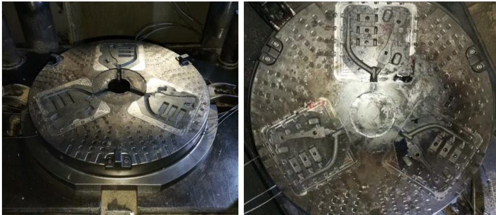
Abbildung 44: Druckgusswerkzeug mit Einsätzen (links: Unterform, rechts: Oberform)
