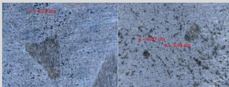
FG 42 Probenoberfläche Thermoschock-Test (5x 900°C) 280x Vergrößerungen hier mit Mikrorissen
