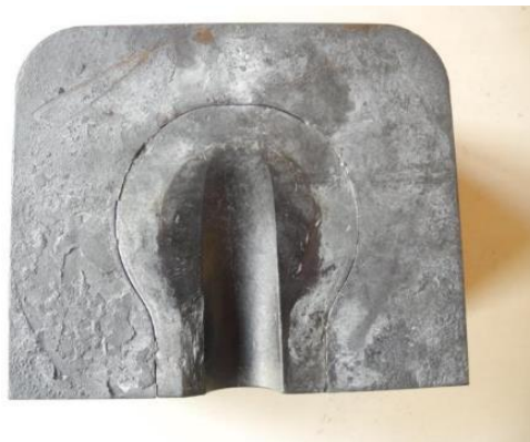
Abbildung 31: Druckstück-Einsatz FG33, hier eingeklebt in den Metallhalter
