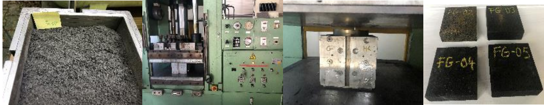
Abbildung 9: Pressen der Mischungen zu CFK-Blöcken 180x180x75mm, in thermisch gesteuerter Presse
