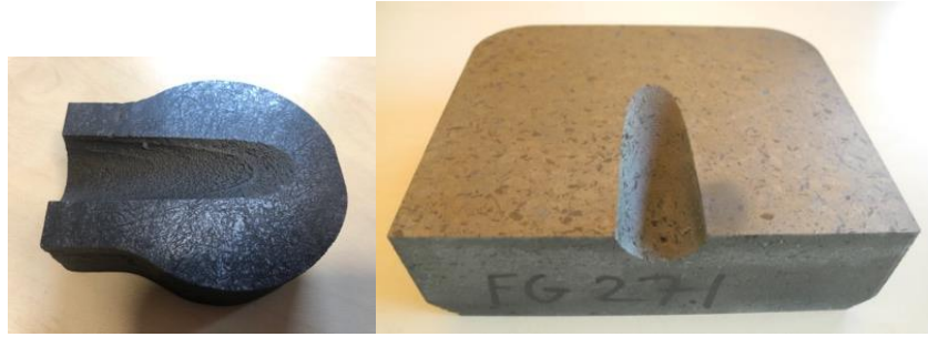
Abbildung 30: Druckstück-Einsatz FG28H, hybrides Material, Druckstück aus FG27.1 Material
