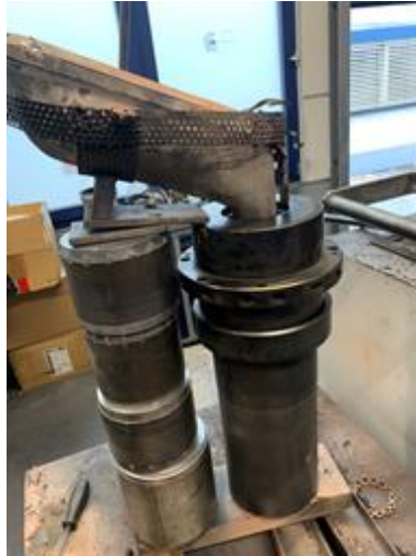
Abbildung 41: Prüfstandsversuch für Bestimmung einer geeigneten Formschichte
