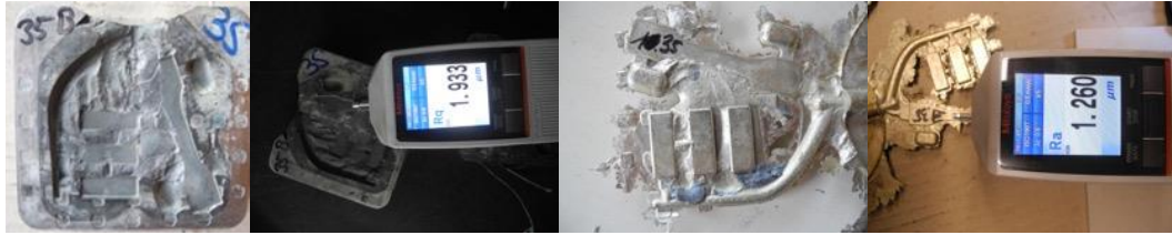
Abbildung 47: FG27, Mikroskopie (links) 100x Oberfläche Gussform, leichtes Ablösen, keine Anhaftung
