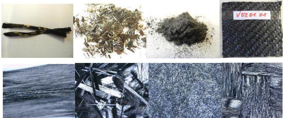
Abbildung 8: Faserarten v.l.n.r.: C-Longfaser, C-Kurzfaser geschnitten, C-gemahlene Fasern, C- Gewebe
