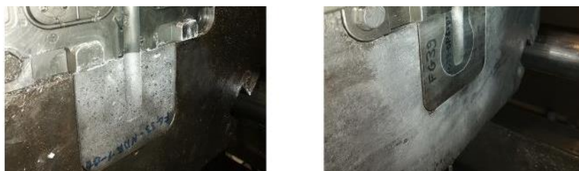
Abbildung 28: eingebauter faserkeramischer Halter (links) und Druckstückeinsatz (rechts)
