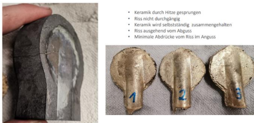
Abbildung 23: Dokumentation einer Schwerkraftguss-Probe am Anfang der Versuchsreihe
