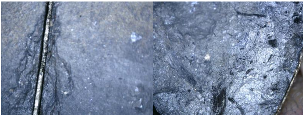
Abbildung 34: Mikroskopie 40x, Abplatzungen Mittellinie /Kontur keine Mikrorisse
