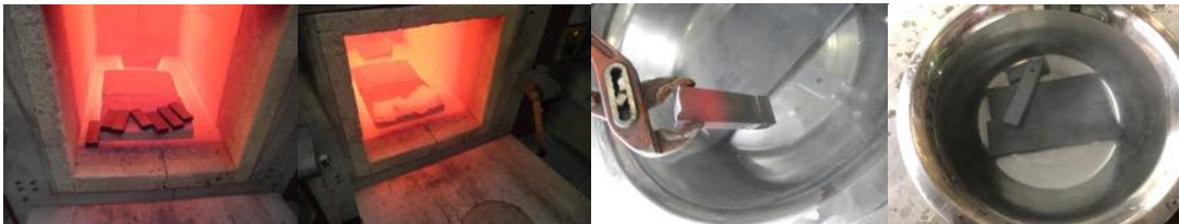
Abbildung 13: Testprozedur Thermo-Schocktest, Delta T=900° C (Aufheizen und Abkühlen)
