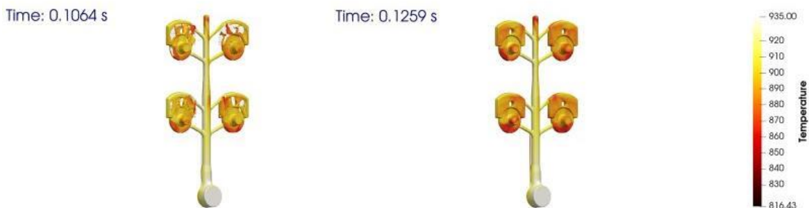
Abbildung 39: Gießsimulation großer Bauteile
