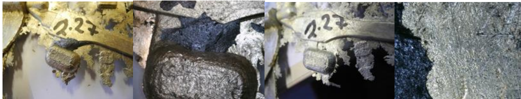
Abbildung 46: FG27, Mikroskopie (links) 100x Oberfläche Gussform, leichtes Ablösen, keine Anhaftung
