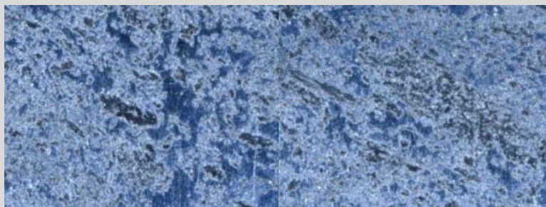
FG 9 Probenoberfläche nach DIP-Test 280x Vergrößerung
