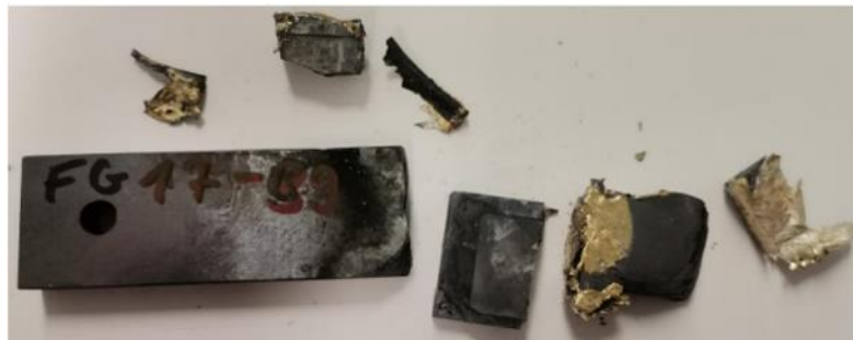
Abbildung 20: Dip-Probe anfangs der Versuchsreihe
