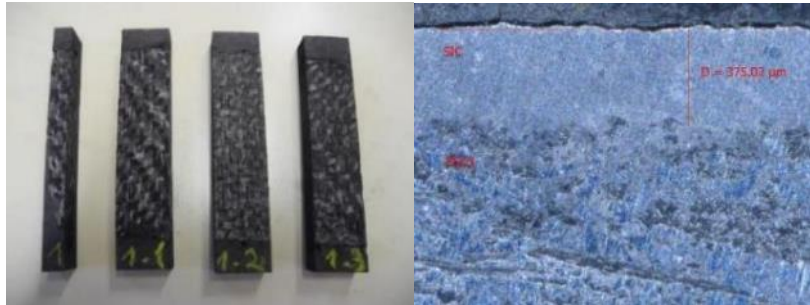
Abbildung 15: hybride C/C Materialproben (links), infiltriert mit SiC-Beschichtung (rechts)
