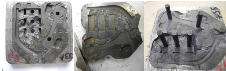
Abbildung 45: Prototyp-Gussform AS/DS nach dem Test mit Auswerfer
