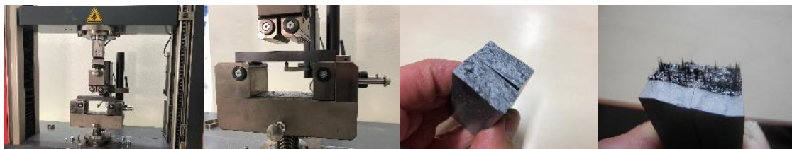
Abbildung 12: 4-Pkt.Biegetest, Zwick Prüfmaschine, Bruchflächen Kurzfaserver- und hybrides Material
