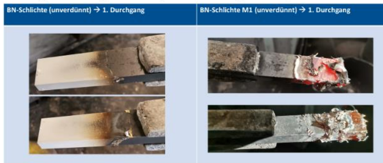
Abbildung 43: Vergleich von Variationen der Bornitrid-Schlichte
