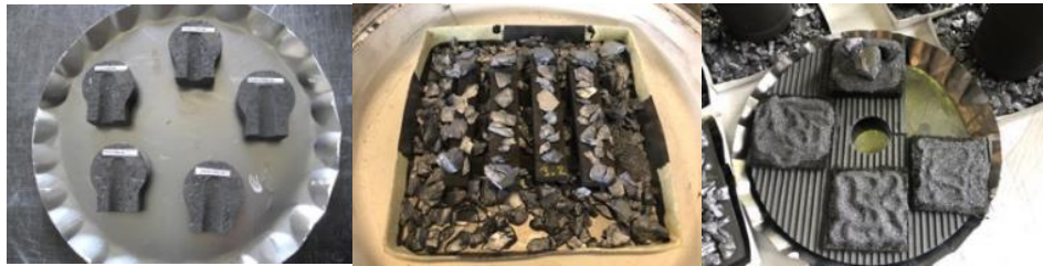
Infiltration der Pressform-Grünbauteile (Anbieten von polykristallinem Si zur Infiltration)
