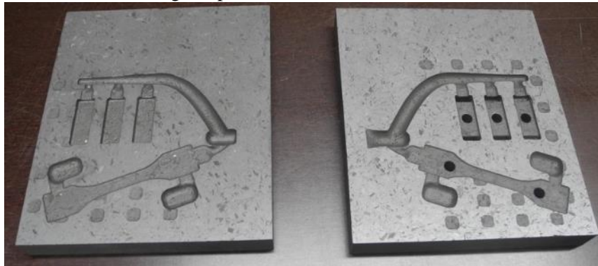
Prototyp-Gussform AS/DS nach Infiltration, Sandstrahlen und Schleifen (vor dem Erodieren)
