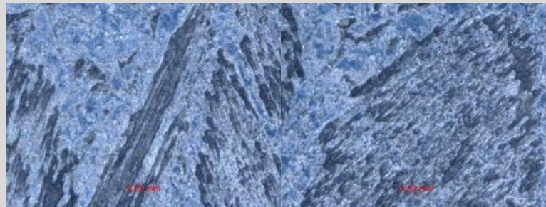
FG 27 Probenoberfläche nach Thermoschock-Test (5x 900°C) 280x Vergrößerung
