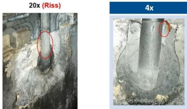
Abbildung 29: Beschädigungsarten der Einsätze (links: Rissbildung, rechts: Aufplatzen der Kante)
