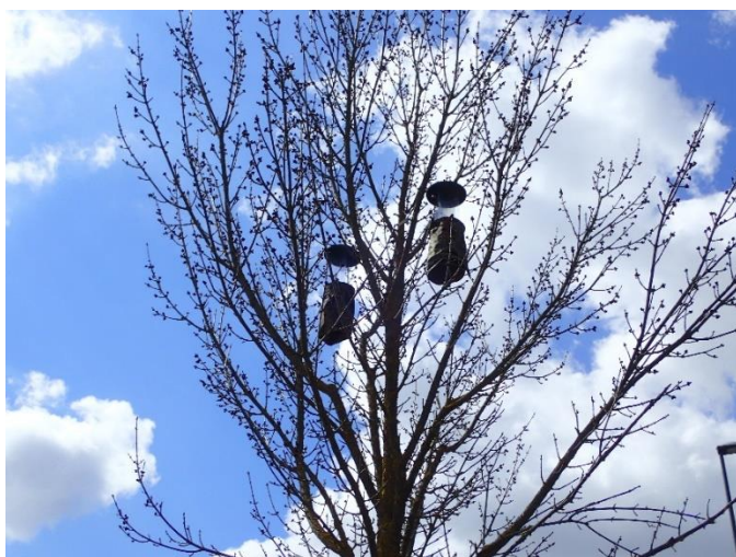
Bild 15: Eklektoren in der Krone von F. pennsylvanica ‚Summit‘ vor dem Blattaustrieb
