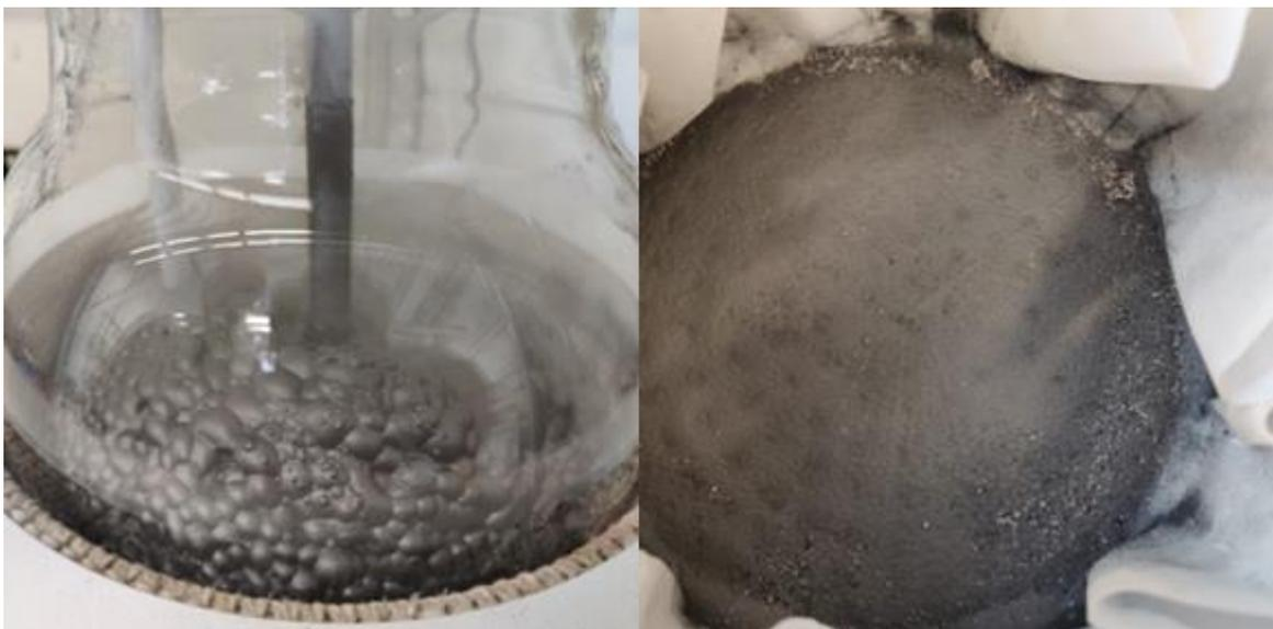
Abbildung 36. (a) Nachreinigung und (b) Filterkuchen der pyrolysierten und gelaugten Proben
