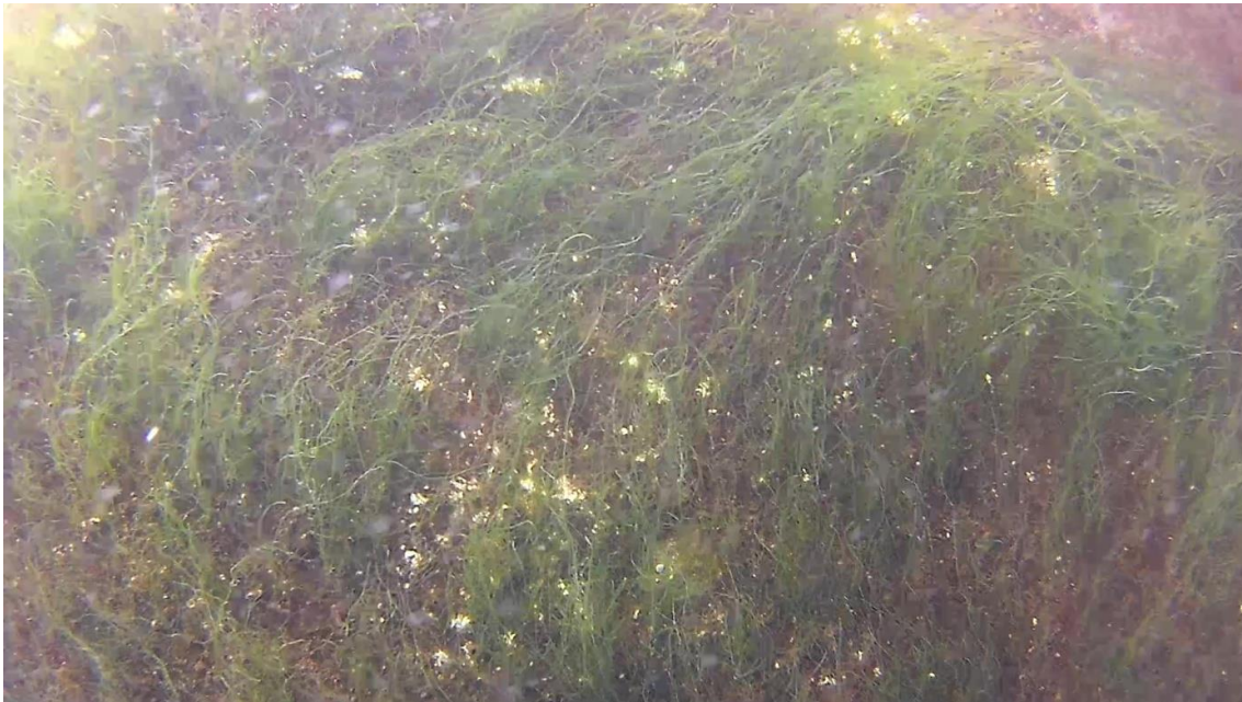
Abb. 22: Testbeschichtung von Momentive/Wohlert auf der „Wega“ im April 2019, 2 Jahre nach der letzten Reinigung mit fädigen Grünalgen und vereinzelt Seepocken, BSH
