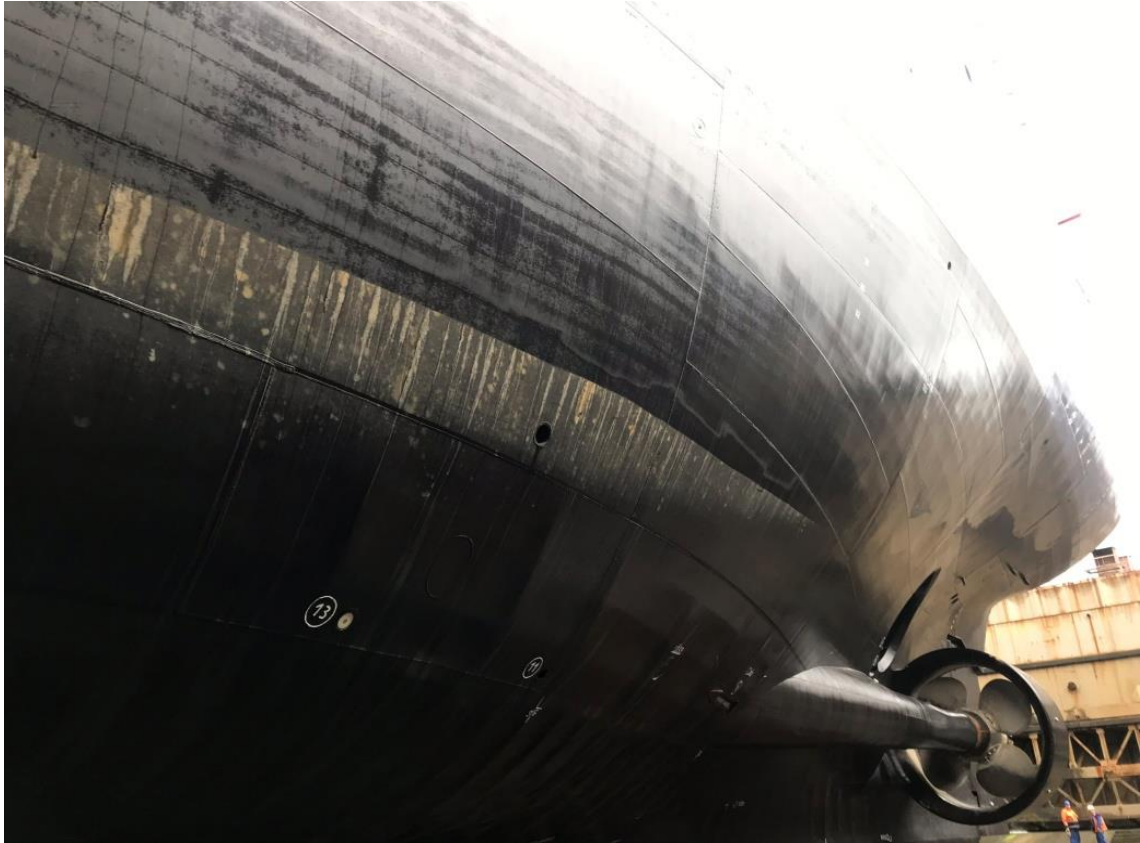
Abb. 8: „Polarstern“ nach der Unterwasserreinigung im Dock, Backbord (Lloyd Werft, Bremerhaven), Juli 2019
