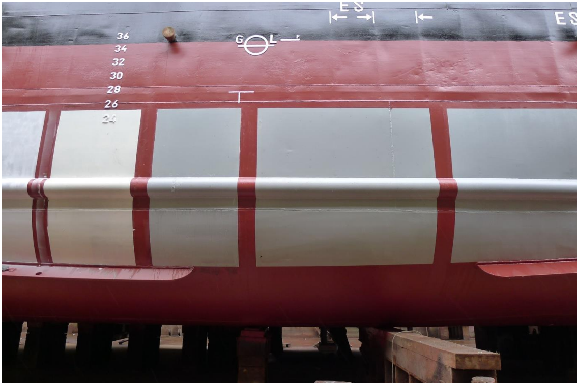
Abb. 27: Antihaft-Beschichtungen auf der Steuerbordseite der „WEGA“ nach Applikation November 2015
