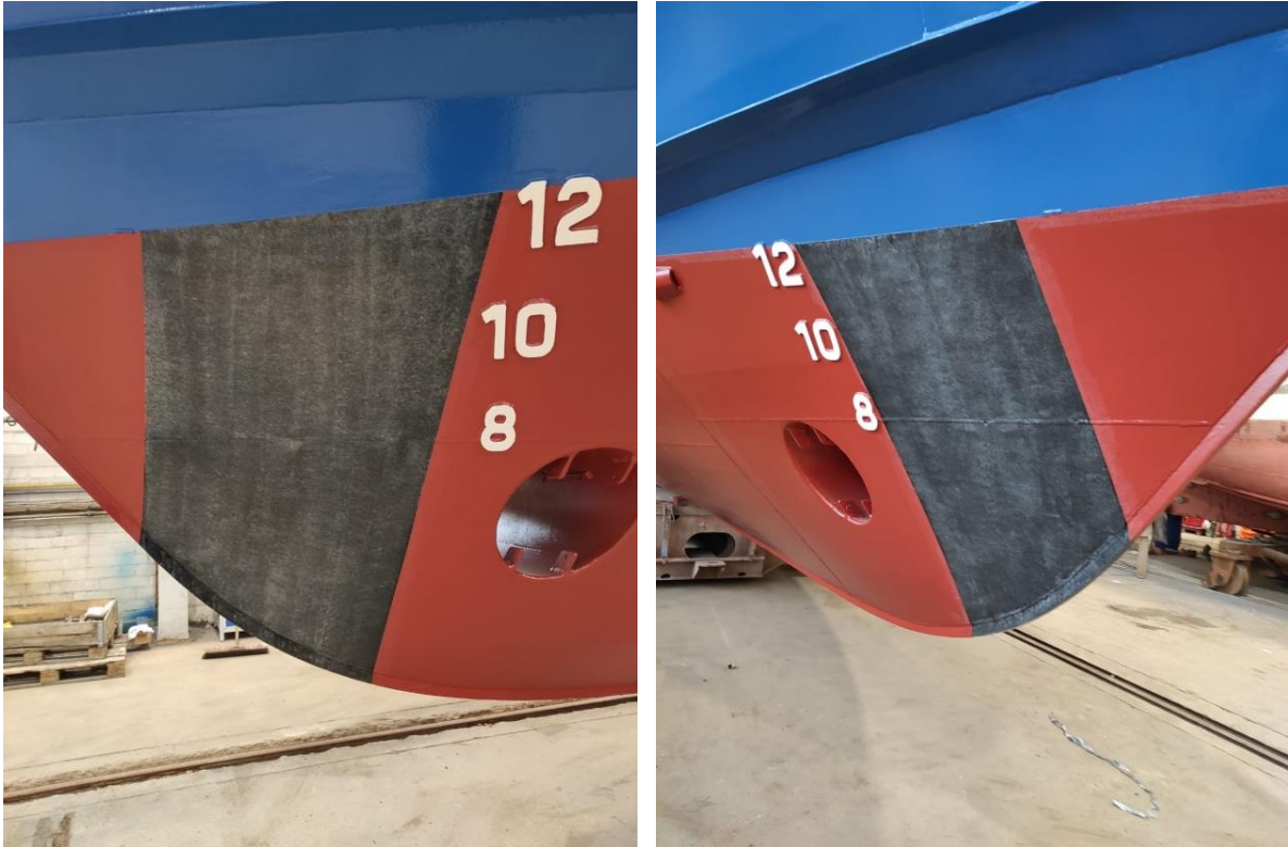
Abb. 36: Overdrive Teststreifen an backbord und steuerbord Bug auf der „W5“
