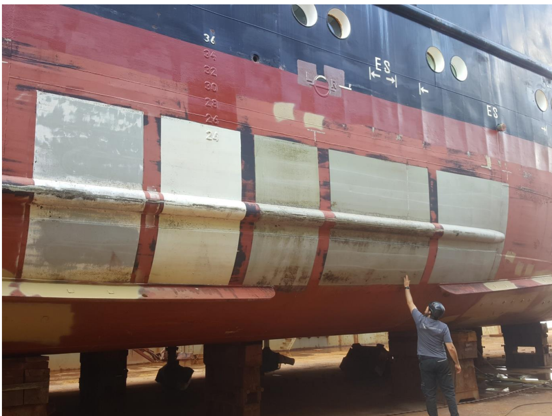
Abb. 31: Antihaft-Beschichtungen auf der „WEGA“ Juli 2019 nach HD-Reinigung im Dock
