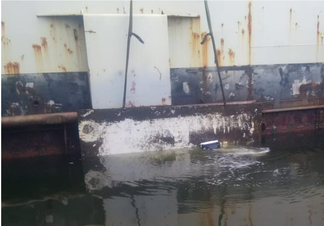
Abb. 44: KeelCrab bei der Reinigung der Stahlplatte, November 2019
