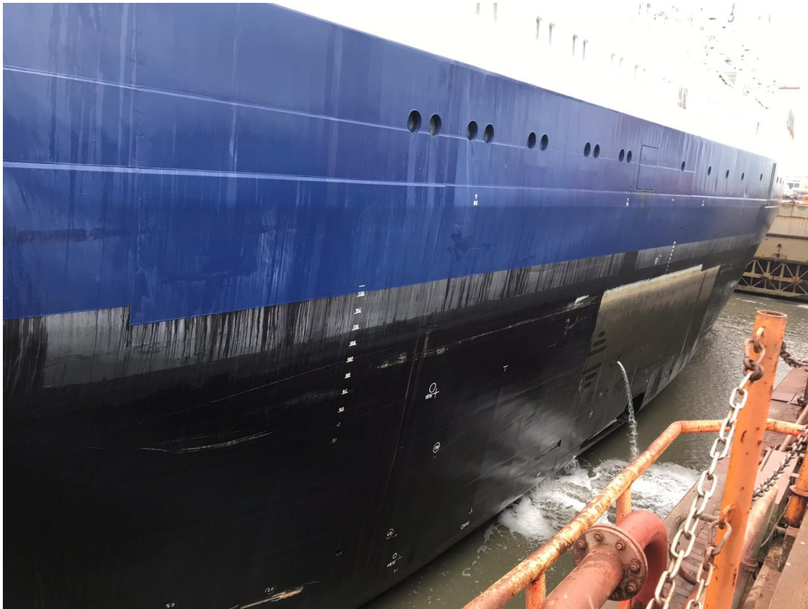
Abb. 7: „Polarstern“ nach der Unterwasserreinigung im Dock, Steuerbord (Lloyd Werft, Bremerhaven), Juli 2019
