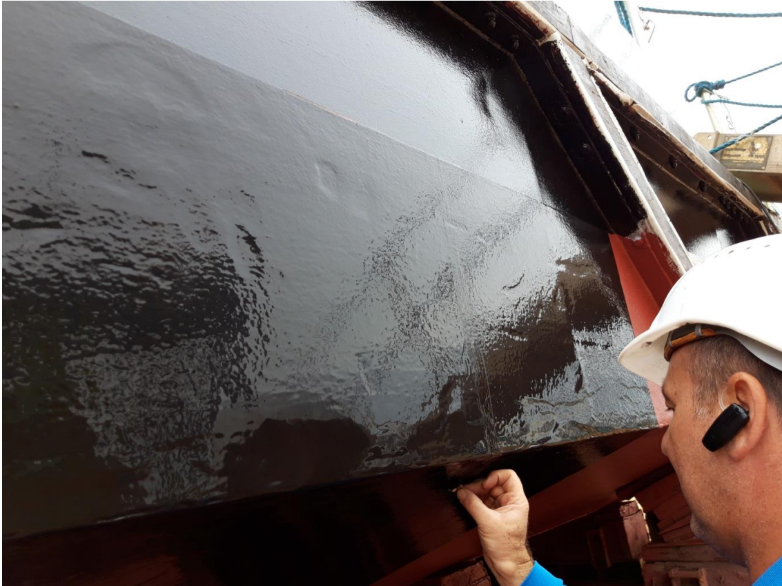
Abb. 38: Antihaftholie „Dolphin S“ auf der „MÖWE“ bei der Applikation August 2019
