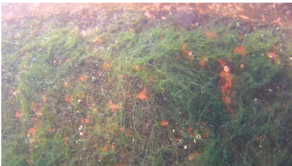
Abb. 15: Reinigungsfähige Beschichtung von Jotun auf der „Wega“ im April 2019, mit dichtem Bewuchs aus fädigen Grünalgen und vereinzelt Seepocken, letzte Reinigung März 2017, BSH
