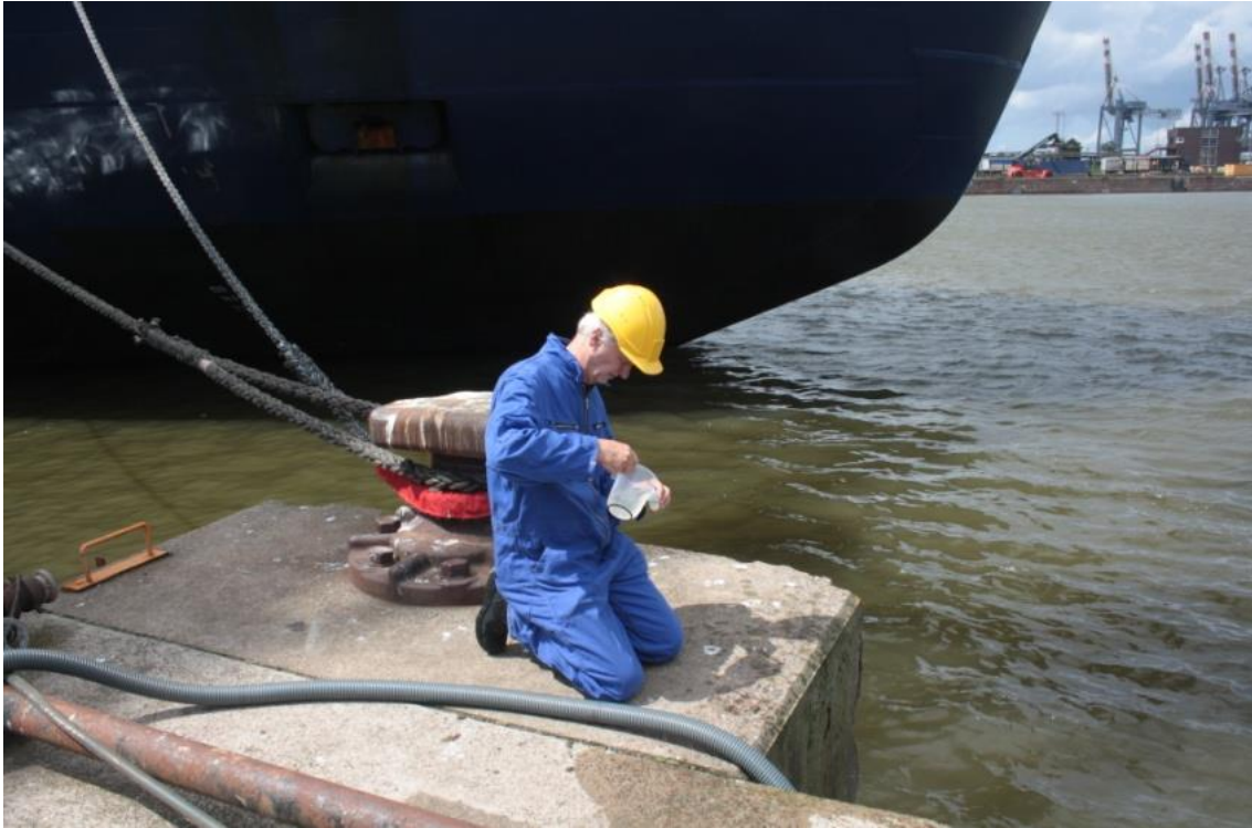
Abb. 11: Entnahme der filtrierten Wasserproben aus dem abführenden Schlauch der Filtrationsvorrichtung
