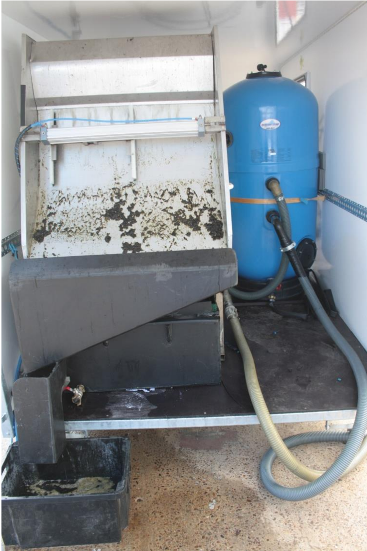
Abb. 10: Filtrationsvorrichtung mit Siebfilter (100 \mu\text{m} ), darunter Vliesfilter 100 \mu\text{m} und Feinfilter (100 \mu\text{m} ) mit abführendem grauen Schlauch, über den das filtrierte Wasser in das Hafenbecken zurückgeleitet wurde
