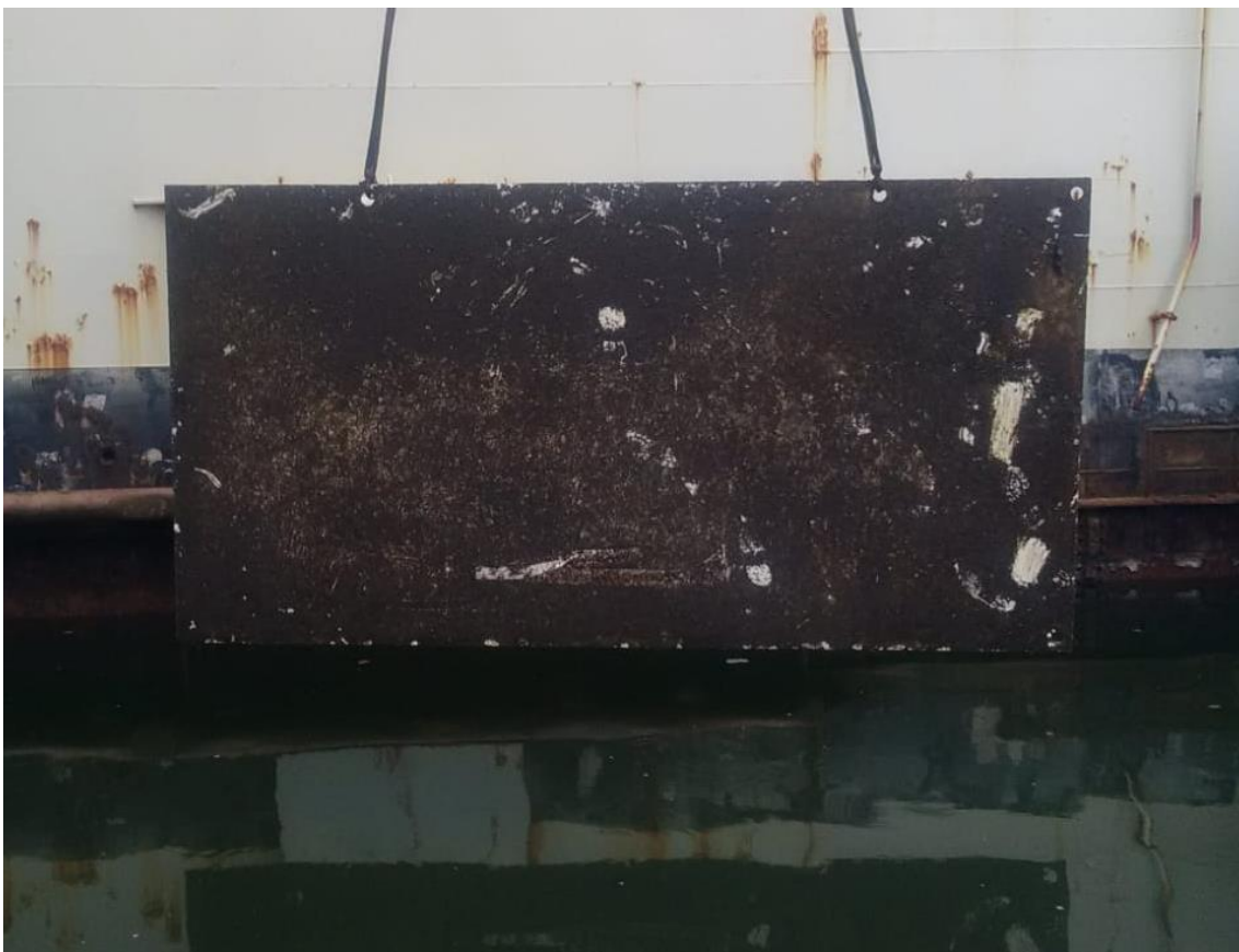
Abb. 43: Stahlplatte nach 7 Monaten Exposition vor der Reinigung
