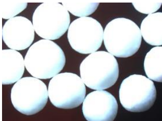
Abbildung 8: Mikroskopbild Spheres vom Technikumsspheronizer
