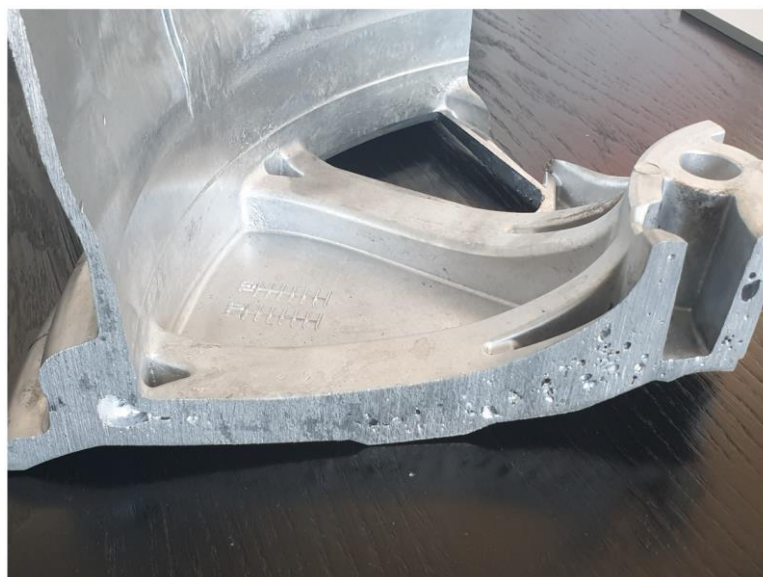
(Abbildung 10: Gießergebnis Schnitt durch Gussteil aus 07.2020)
