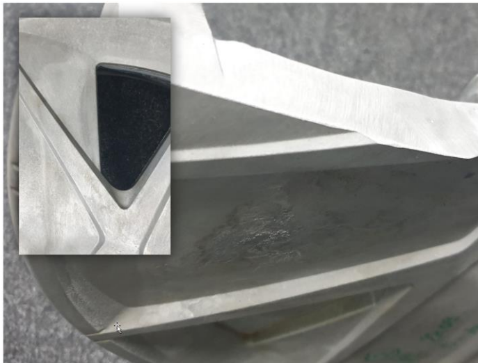
(Abbildung 12: Gießergebnis Schnitt durch Gussteil aus 09.2020)
