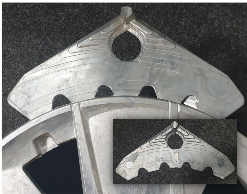
(Abbildung 8: Gießergebnis Entlüftung FS oben aus 07.2020)
