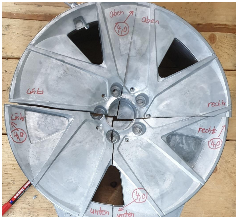
(Abbildung 15: segmentiertes Gussteil nach Optimierung inkl. Wanddickenmessung)
