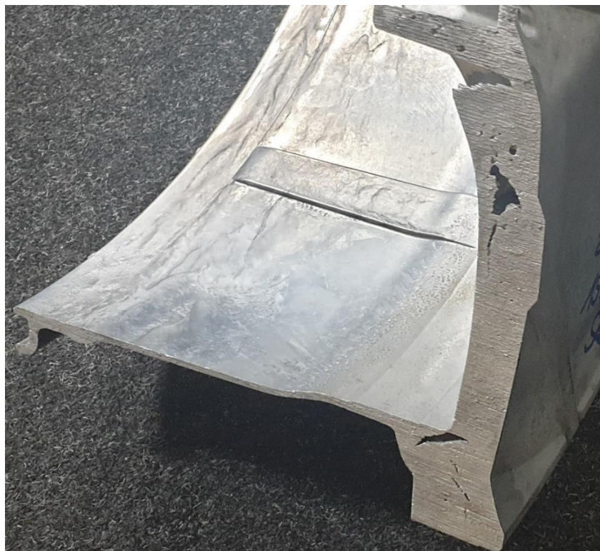
(Abbildung 3: Gießergebnis Schnitt durch Gussteil aus 01.2020)
