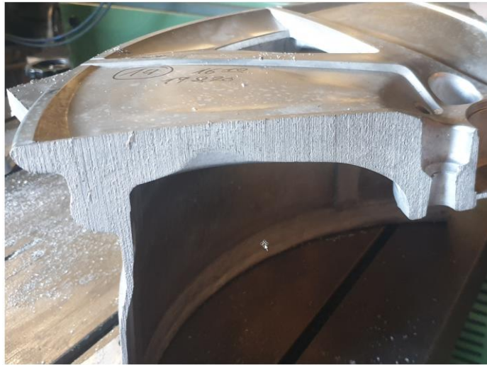
(Abbildung 11: Gießergebnis Schnitt durch Gussteil aus 08.2020)
