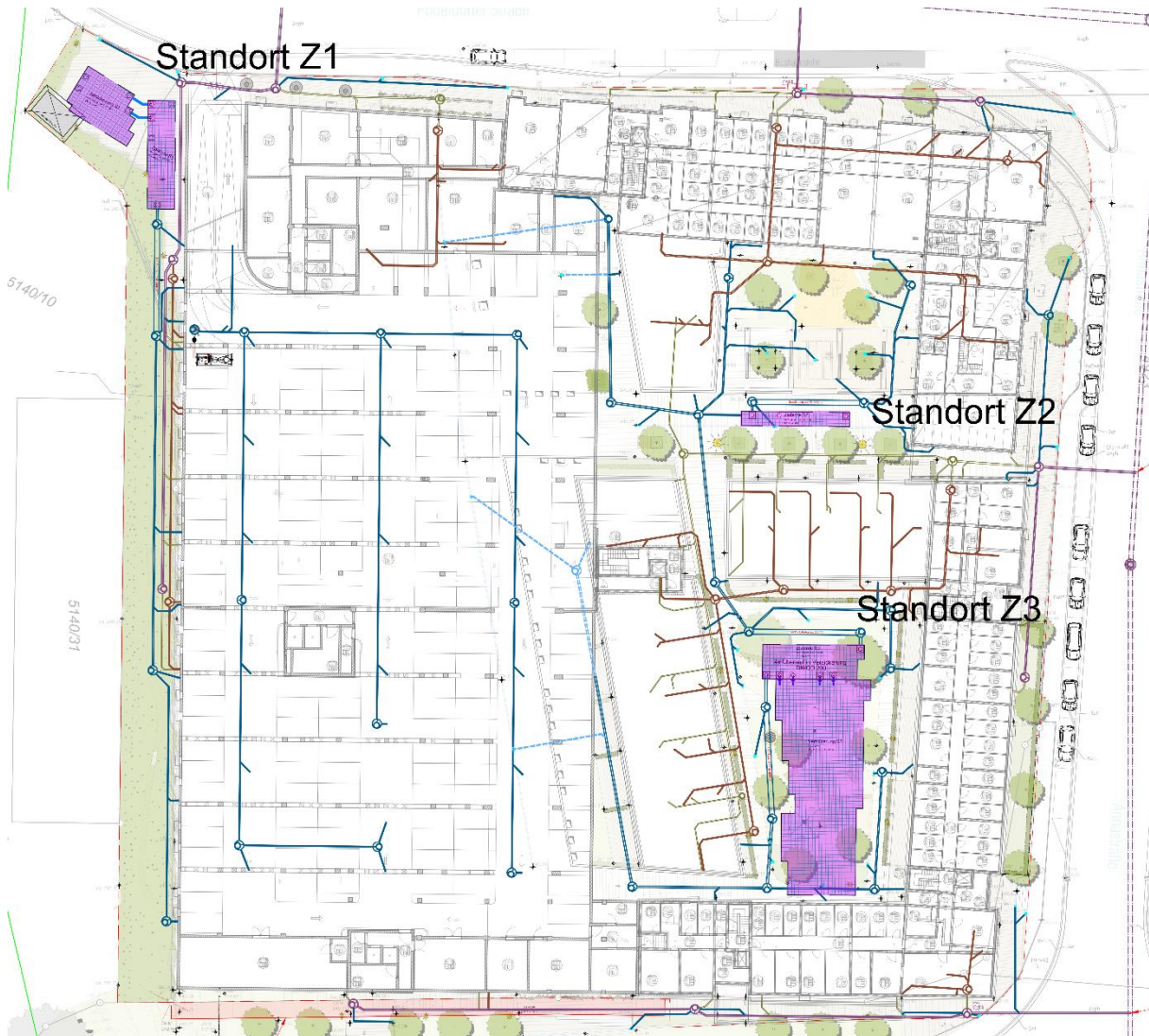
Abbildung 10: Genehmigungsplanung Entwässerungsantrag. Dargestellt ist die Planung der unterirdischen Bauwerke bestehend aus Rigolen, Zisternen (violett) und Grundleitungen, welche abschließend zur Genehmigung eingereicht wurde. Rennert Ingenieure, Bamberg
