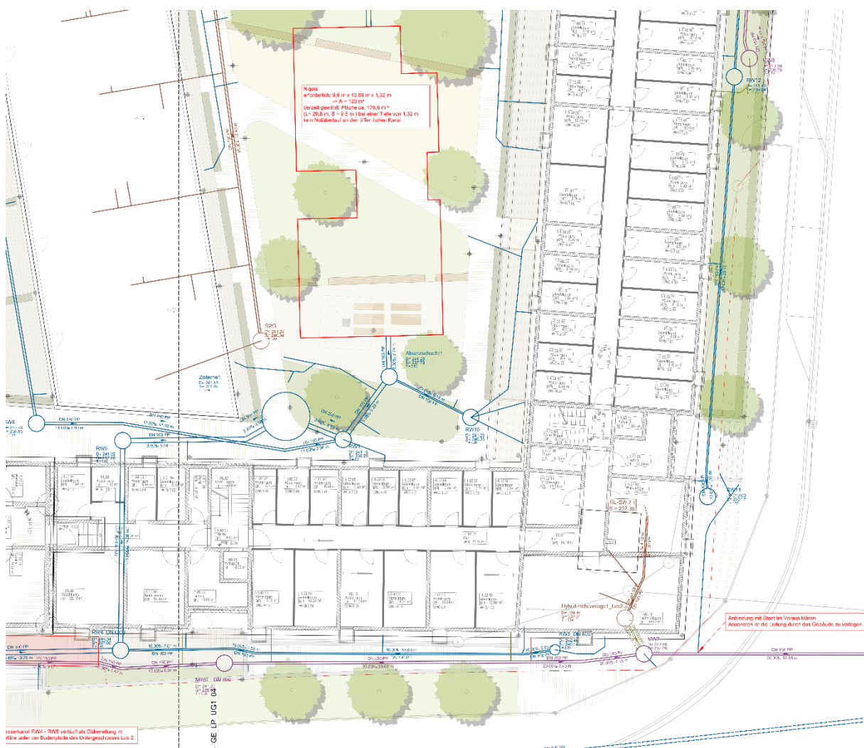
Abbildung 4: Ausschnitt Entwässerungsplanung Stand 31.07.2019 Ausgangssituation. Dargestellt die Rigole (rot umschlossene Fläche) mit einer vorgeschalteten Zisterne. Aufwendige Anbindung der südlichen RW-Leitungen über Düker-Konstruktion unterhalb des Gebäudes.
