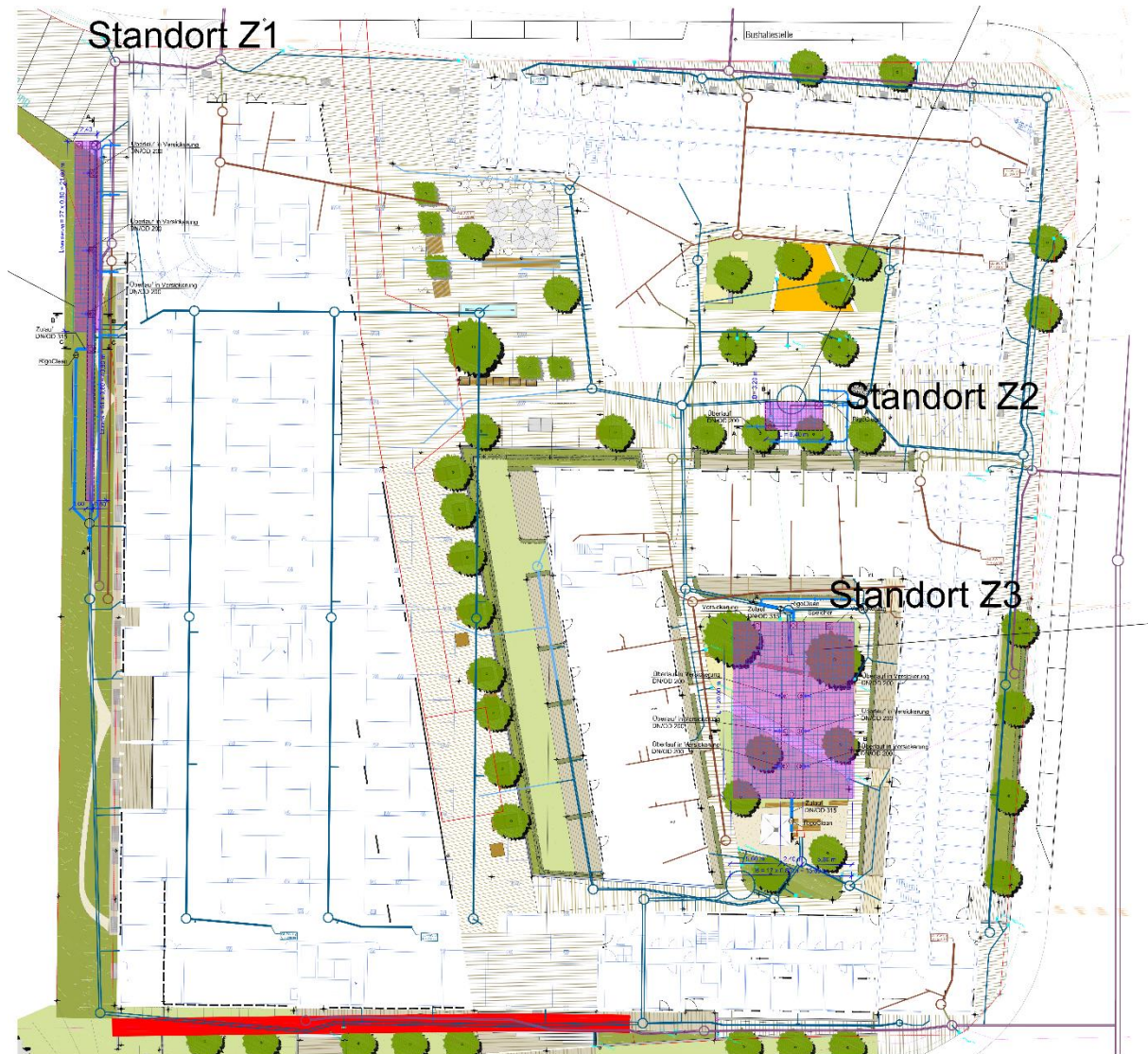
Abbildung 9: Grundleitungsplan Entwässerung. Dargestellt ist das Konzept der unterirdischen Bauwerke bestehend aus Rigolen und Zisternen (violett) (Quelle: Rennert Ingenieure, Bamberg).
