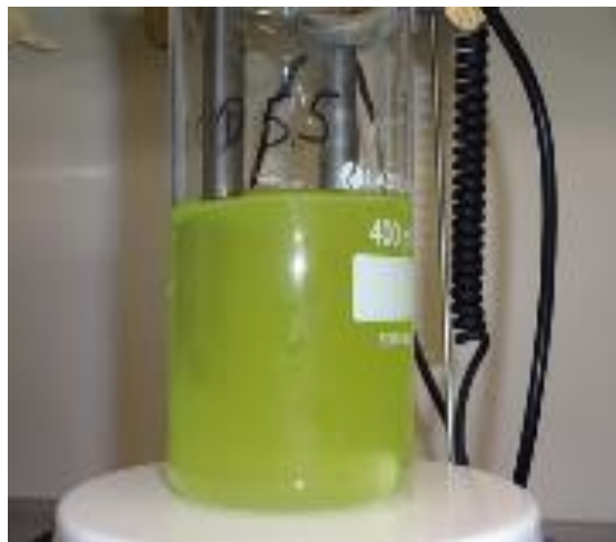
Abbildung 1: Versuchsaufbau der Lösungsversuche am Beispiel Oxalsäure
