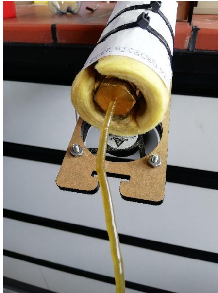
Abbildung 8: Extrusion von PAN-SKA im Miniextruder.
