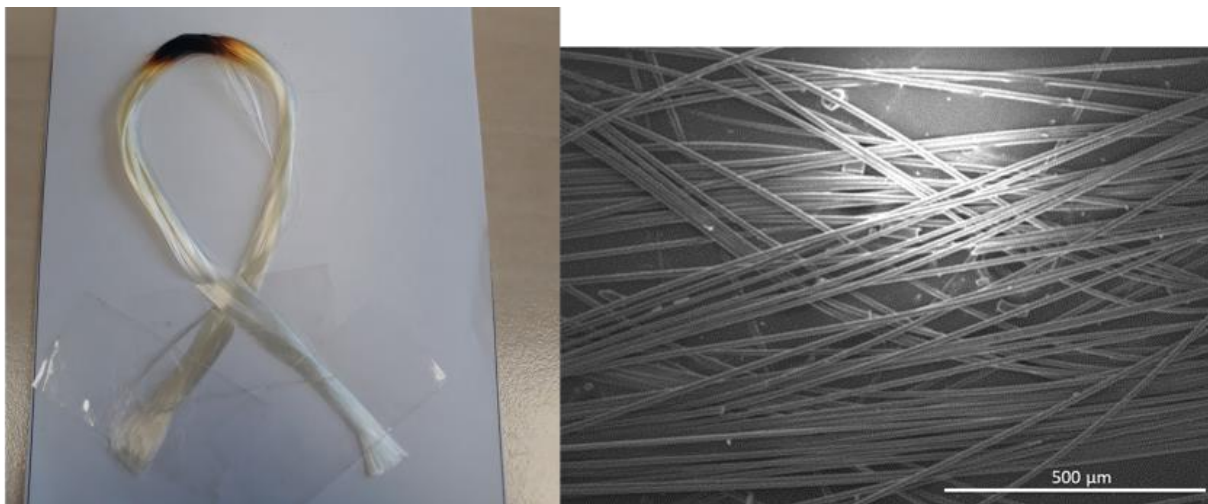
Abbildung 25: Stabilisierungsergebnis mit SF-Jet bei senkrechter Behandlung 150 W.
