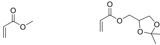
Abbildung 3: Strukturformeln von Methylacrylat (links) und Solketalacrylat (rechts).
