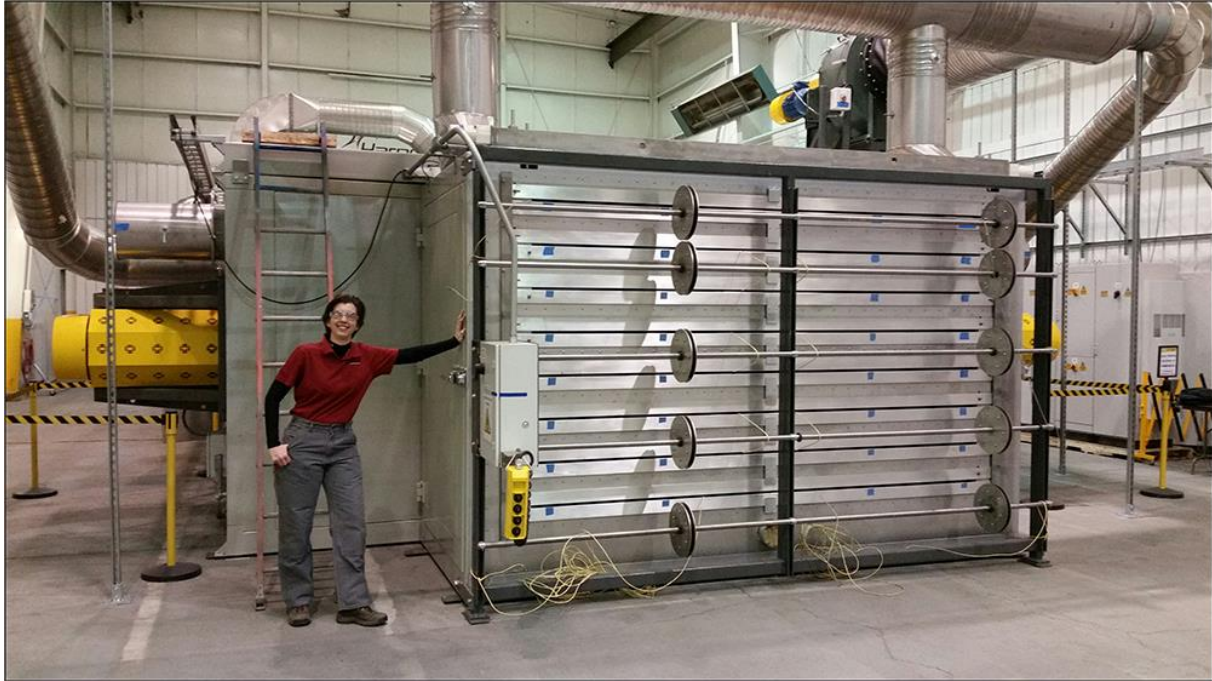
Abbildung 11: Konventioneller Stabilisierungsofen der Firma Harper, 3m hoch [12].
