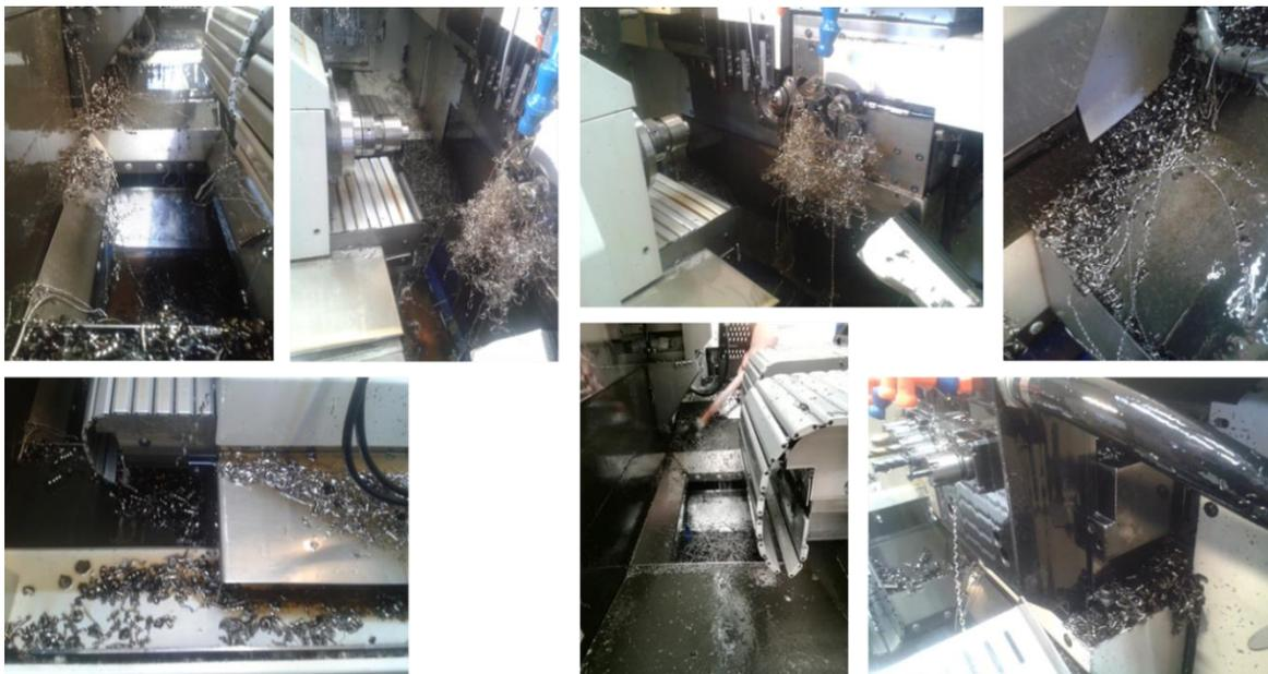
**Abbildung 2: Späneansammlungen (sog. „Spänenester“) bei Überflutungskühlung, nahezu alle Oberflächen des Arbeitsraums sind ölbenetzt**
