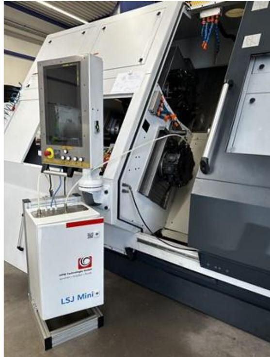
**Abbildung 24: MMS Gerät LSJ Mini von HPM angeschlossen an die Langdrehmaschine**
