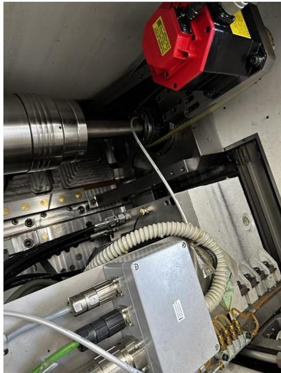
**Abbildung 25: Zuführung des MMS Mediums direkt an die Führungsbuchse über Schmierleitung**
