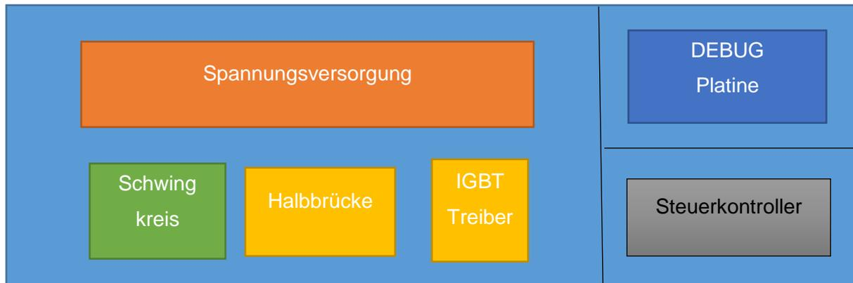
Abbildung 3: Darstellung des Platinenaufbaus
