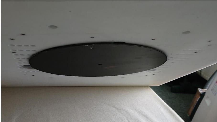
Abbildung 5: Heizblech auf der Gegenseite der Isolationsplatte
