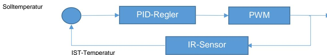
Abbildung 8: Regelschleife Temperaturregelung
