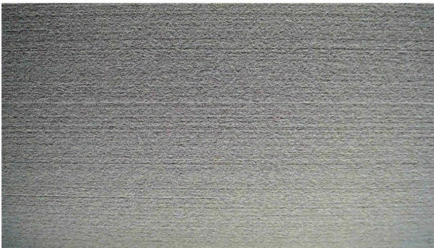
Abbildung 3-17: Beschichtungsversuch 2 100% Überkorn (50-70 µm)
