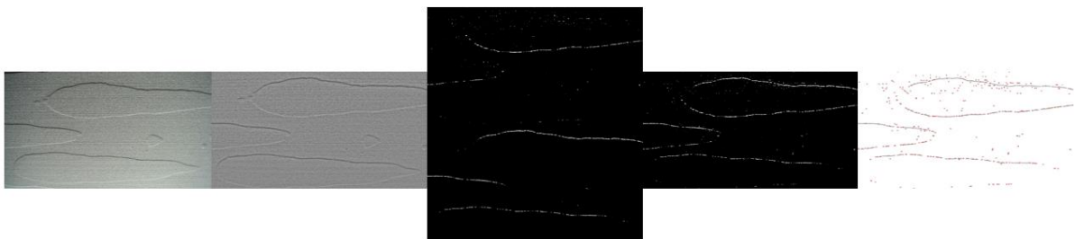
Abbildung 3-7 v.l.n.r. Originalbild; S-W-Bild; Dupliziertes Bild mit Thresholding lights und darks; Rekombiniertes Bild; Ausgewertetes Bild
