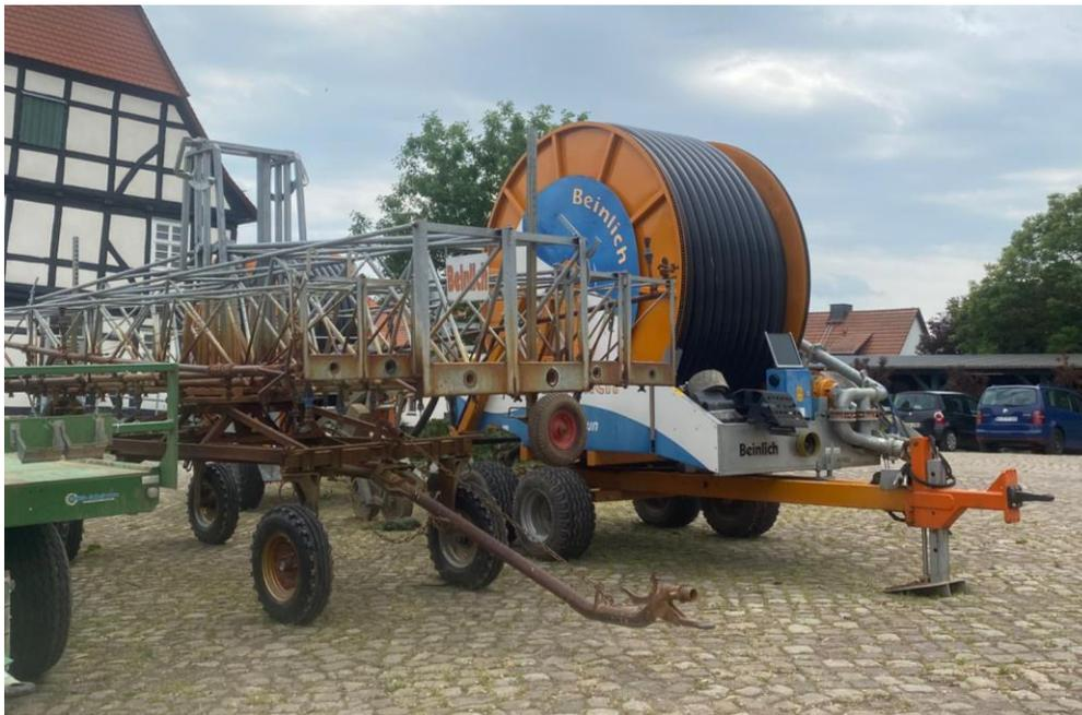
Abbildung 5: Mobile Beregnungsmaschine mit Düsenwagen (links im Bild) der Staatsdomäne Frankenhausen, Quelle: Eigene Abbildung (2022)
