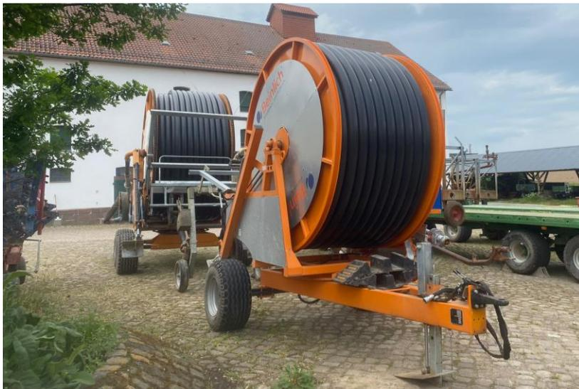
*Abbildung 4: Mobile Beregnungsmaschine (PE-Rohr mit einem Außendurchmesser von 110 mm und 300 m Gesamtlänge) mit Einzelregner der Staatsdomäne Frankenhausen, Quelle: Eigene Abbildung (2022)*
