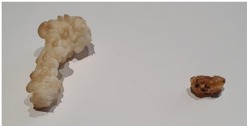
*Abbildung 11: Hotmelt funktionell (links) und nach dysfunktionalen Verkokungen (rechts)*
