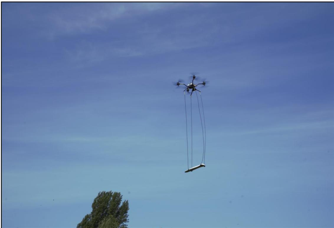
*Abbildung 3 Das entwickelte Messsystem mit Drohne und abgehängtem Magnetometer im Testeinsatz.*
