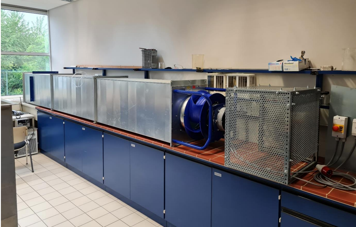
Abbildung 3: Strömungskanal mit Ziehl-Abegg Ventilator im Labor der TH Bingen
