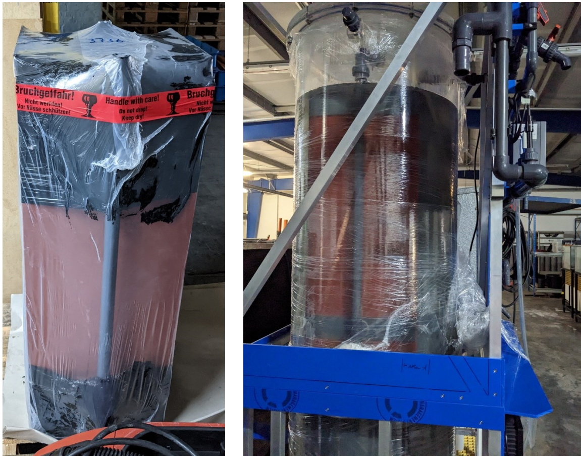
Abb. 28: Links: Membranmodul (BFM); Rechts: Membranmodul nach Einbau in Reaktor
