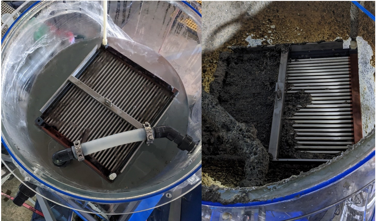
Abb. 29: Membranmodul im halbtechnischen MDR von oben. Links: nach Einbau, Rechts: nach 82 d Betrieb, Teilstück rechts wurde von oben mit Wasser abgespritzt
