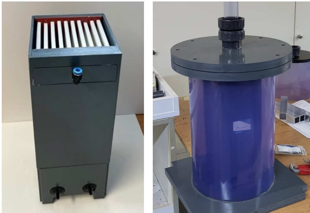
Abb. 13: Links: Membranmodul (BFM); Rechts: Membranmodul nach Einbau in Laborreaktor (Abmessungen s. Tab. 4, bzw. Tab. 5)
