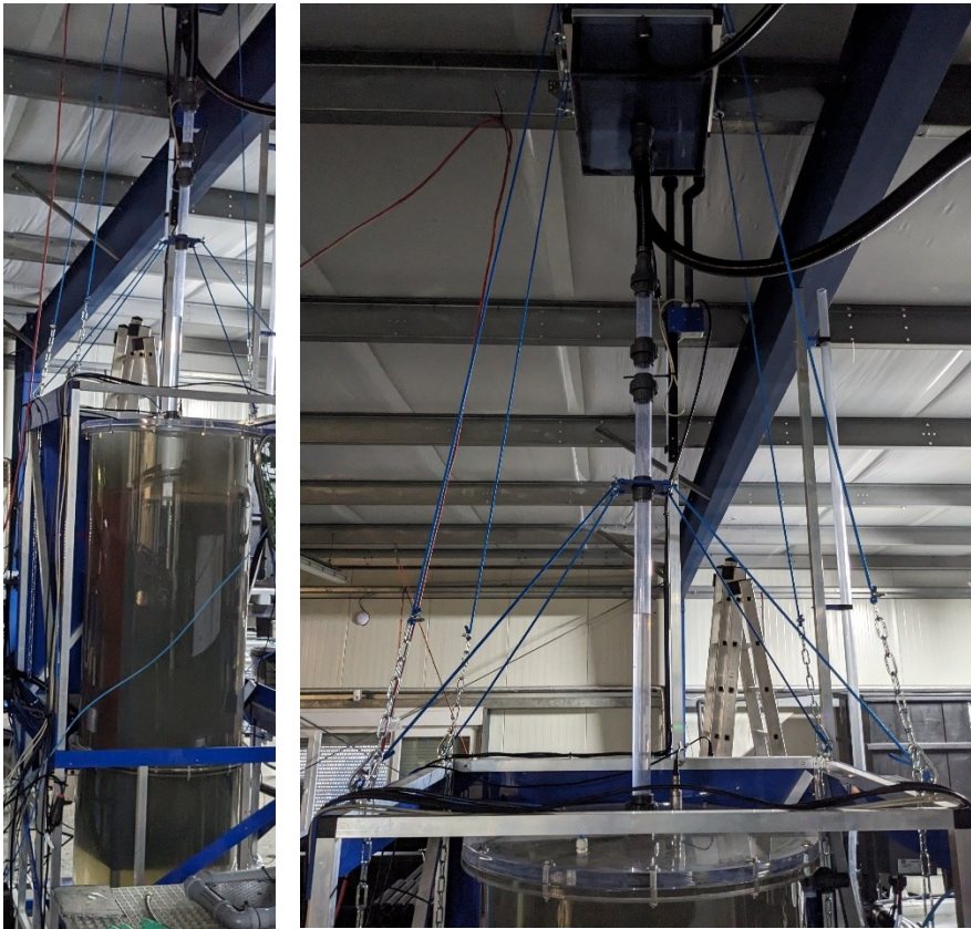
Abb. 31: Halbtechnischer Reaktor in der Forschungshalle InfiniteSea nach dem Aufbau. Links: Reaktor (von hinten); Rechts: Deckel, Steigrohr und Ausgleichsbehälter
