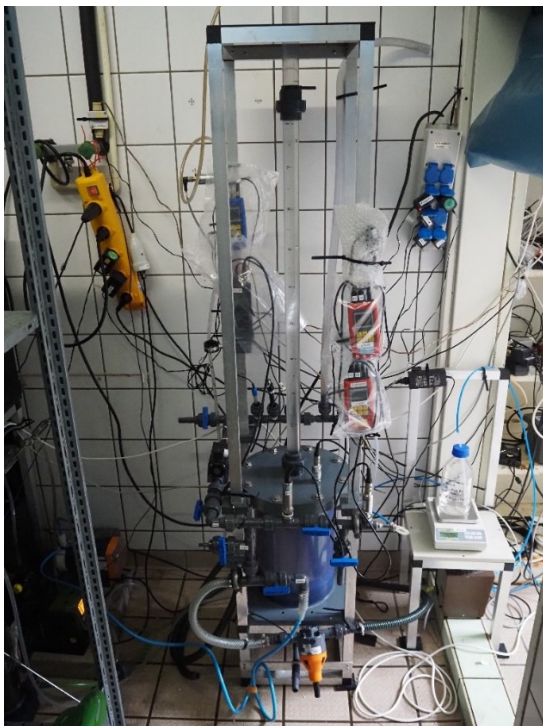
Abb. 24: In Betrieb genommener MDR in Hannover inklusive technische Apparatur und Messseinheiten
