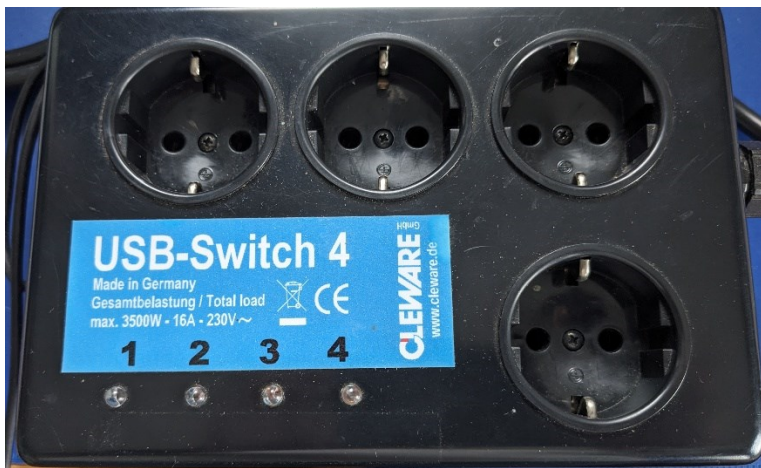
Abb. 2: Schaltsteckdose USB-Switch 4 (Cleware) für die Beschaltung der Aktoren Deni-Pumpe, MV1, Rückspülpumpe und Dosierpumpe
