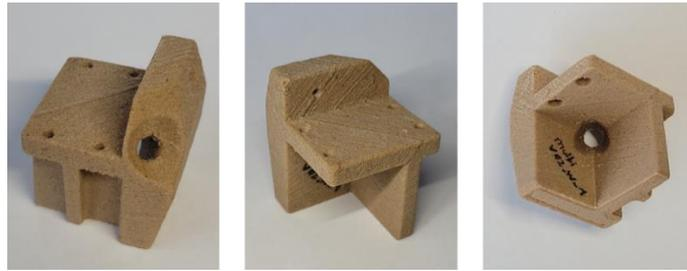
Abbildung 7-20 Beispielhaftes Betriebsmittel aus PE-Wood Compound
