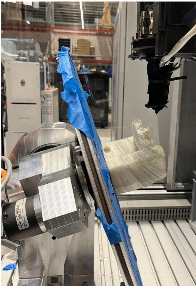
Abbildung 11-13: AP 4.3 5-Achsiger Bauteildruck des Bauteils „Schweißvorrichtung“ in Originalgröße
