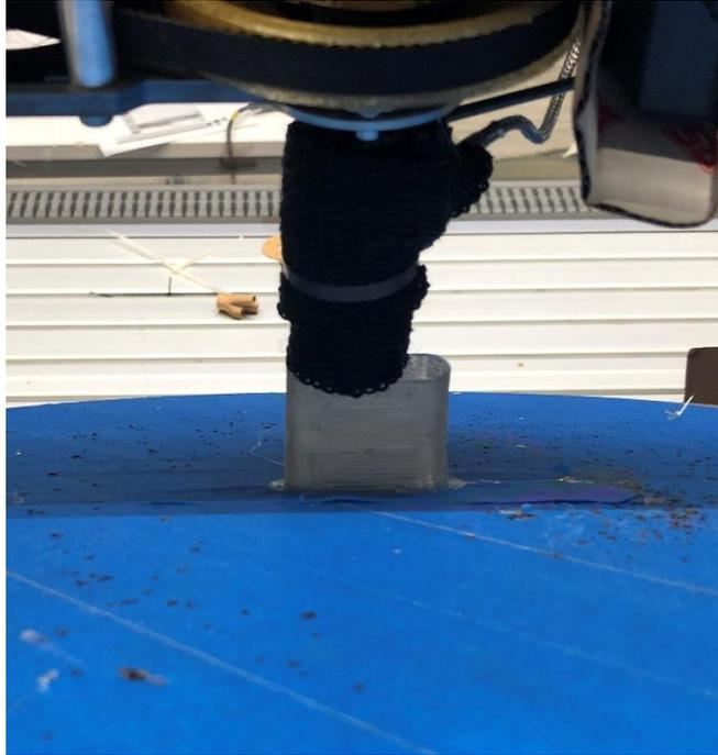
Abbildung 7-14: Druck einer im Programm von ModuleWorks geslicten Basisgeometrie
