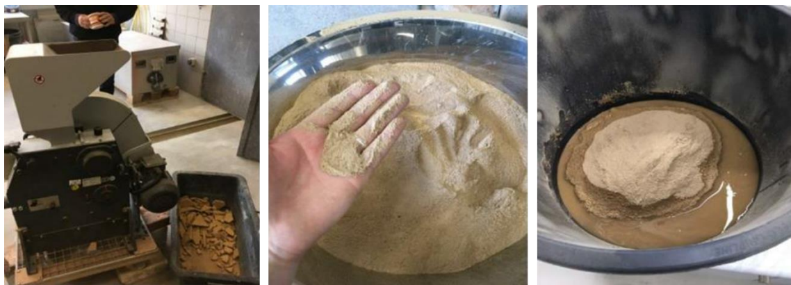
Abb. 3.5.2: Trockenverfahren zur Aufbereitung und Wiederverwertung vom Lehmabbruchmaterial
