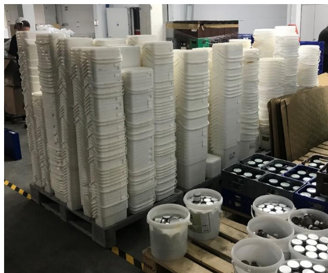
Abbildung 5: Sortierung der Kunststoffeimer aus lebensmittelechtem Polypropylen vor der Reinigung (Quelle: eigenes Bild)
