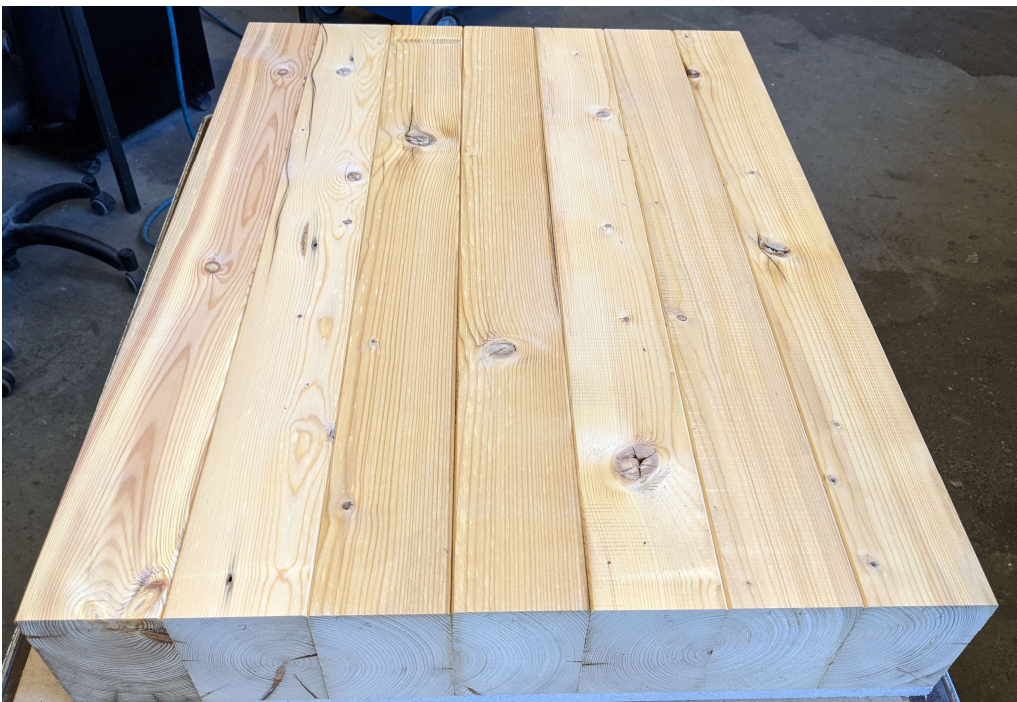
Abbildung 39 Kleinformatige nichttragende Außenwand ohne Dämmmaterial
