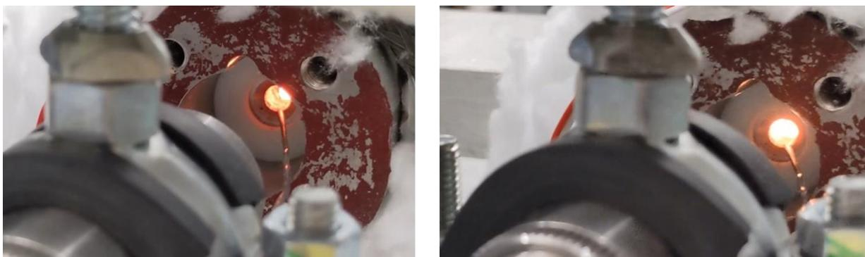
Abbildung 25: Standbilder aus Videoaufnahme; links: vor der Funkenbildung; rechts: aufgehellte Messkammer aufgrund der Funkenbildung.
