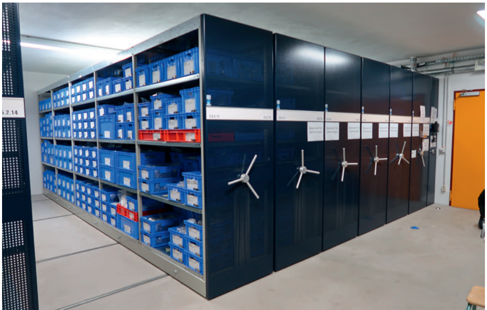
Abb. 11: Gefülltes Rollregal aus wärmeleitendem Metall: Dichter Deckel und dichter Sockel erzeugen einen blockhaften Zustand, wenn das Regal zusammengeschoben ist. Rechts über der Tür an Innenwand Auslass der Klimaanlage; Einlass gegenüber an der Außenwand, links im Mittelgang (Foto G. Krüger).
