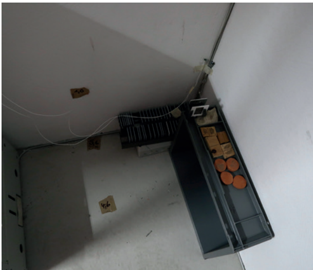
Abb. 21: An einer Außenwandoberfläche montierter Datenlogger mit Sensor für Luftfeuchtigkeit und Temperatur zur Messung der Wandtemperatur/-feuchte; daneben Pilzprüfplättchen nach Abe (Diarähmchen) bzw. mit Staub und Pilzsporen beimpfte Keramik- und Holzplättchen (Foto G. Krüger).
