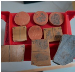
Abb. 22 bis Abb. 24: Pilzprüfplättchen nach Abe (1996): Diarähmchen mit Zellophanfolie mit drei unterschiedlichen Pilzen beimpft (Abb.22 / oben, Abb. 23 / Mitte). Keramik- und Holzproben mit Staub und Pilzen beimpft (Abb. 24 / unten) (Fotos G. Krüger).
