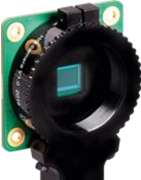
Abbildung 4 HQ-Kamera mit SONY IMX477R Sensor 2020 © SONY
