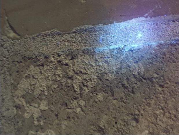
Abbildung 25 Fluoreszenz im Mörtel 2020© iXtronics-Hajuveda
