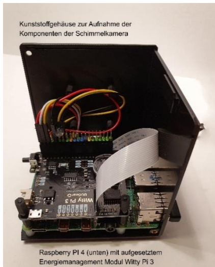
Abbildung 8 Kunststoffgehäuse Schimmelkamera mit PI 4 und Witty 2021© iXtronics-Hajuveda
