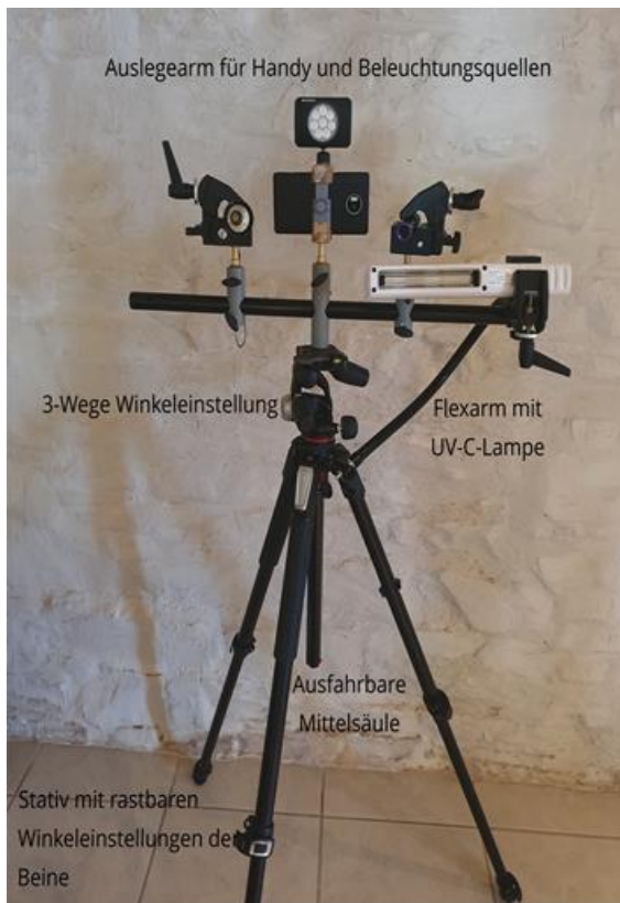
Abbildung 17 Schimmelstativ mit allen notwendigen Komponenten und Beleuchtungen 2020© iXtronics-Hajuveda
