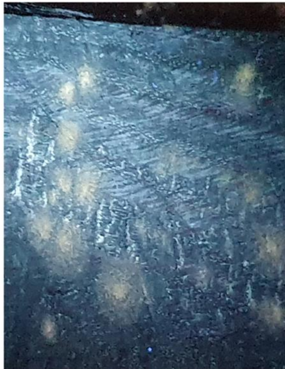
Abbildung 19 Sichtbarkeit von Schimmel bei VIS- und UV-Beleuchtung 2020© iXtronics-Hajuveda
