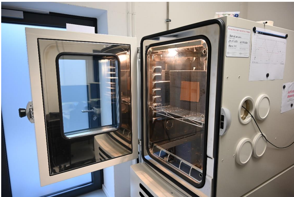
Abb. 14 Aufbau der Messsituation bei offener Klimaschranktür und mit eingestellter Glasplatte.
