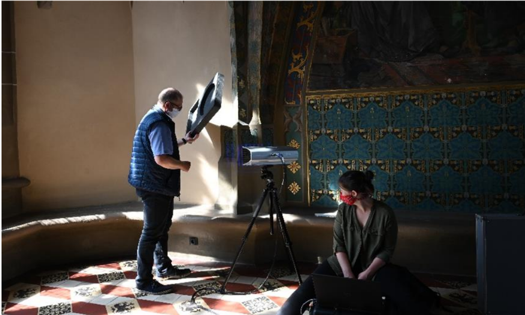
Abb. 22: Links: Aufnahme der gelockerten Wandmalerei im Großen Appellationszimmer in Schloss Albrechtsburg. Das durch die Fenster einfallende Licht wird mit einer provisorischen Verschattung während des Scanprozesses abgehalten.
