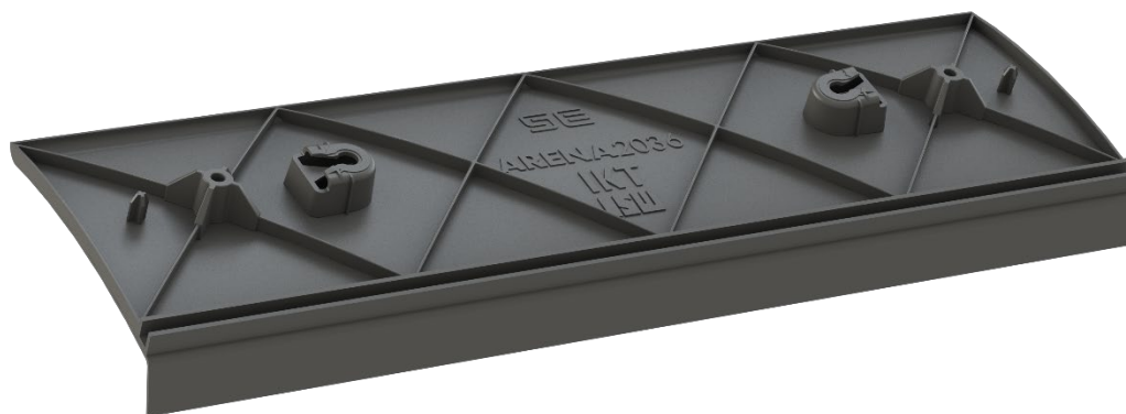
Bild 10: Entwickelte dünnwandige Versuchsgeometrie mit Rippenstruktur und Funktionselementen
