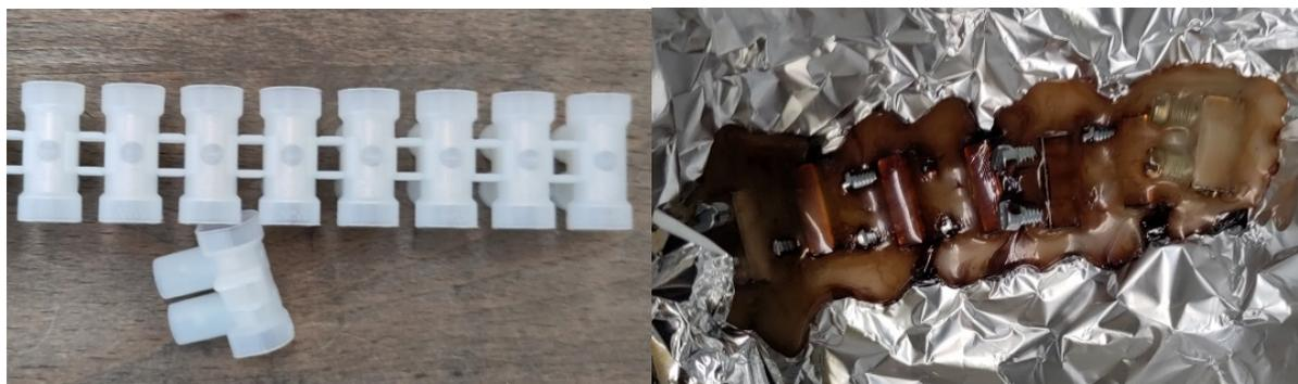
Abbildung 38: Lüsterklemme vor (links) und nach (rechts) der Verschmelzung
