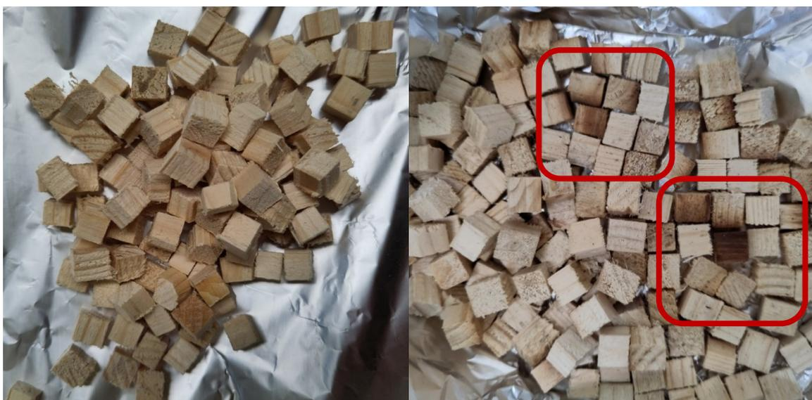
Abbildung 36: Holz vor (links) und nach (rechts) der Verschmelzung, rot dargestellt sind angeschwelte Bereiche
