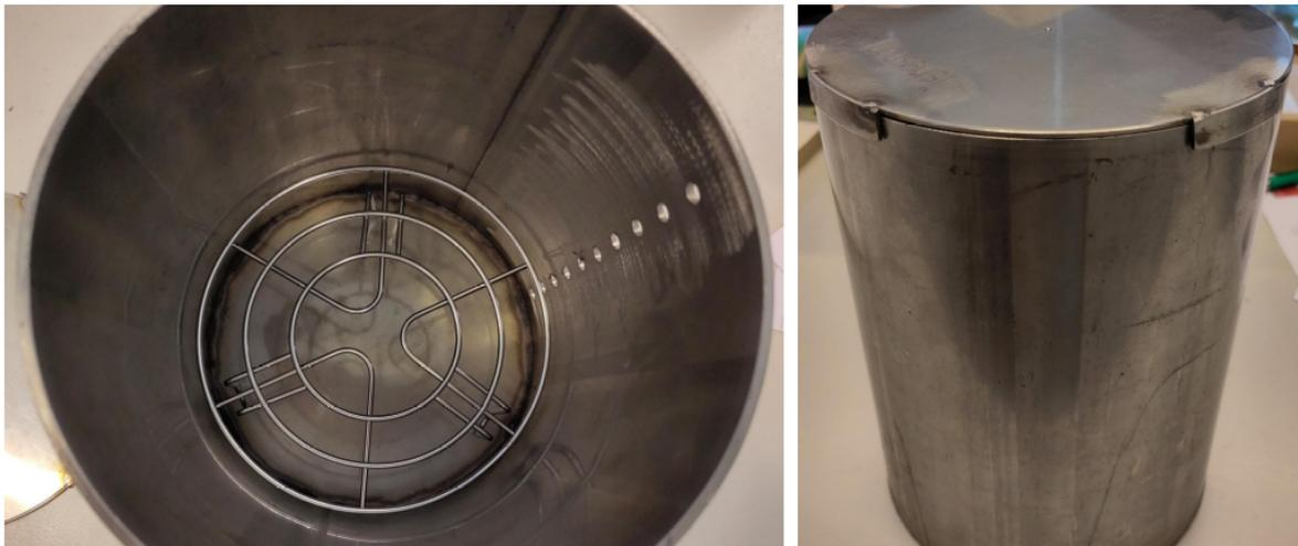
*Abbildung 29: Schwelkammer für die Versuche in der Demonstrationszelle*
