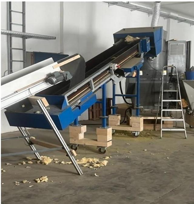
Erema PCU (pre condition Unit oder kumulative Aufbereitungsanlage mit Zuführung über Förderbänder und integrierten Metalldetektor. Der beim Zerkleinern entstehende Staub wird nach oben abgesaugt.
