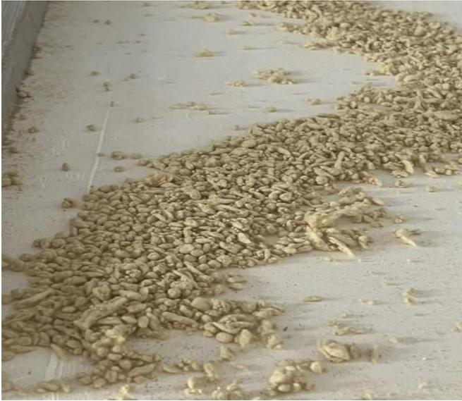
Auslauf Rutsche aus der Siebmaschine zum Abfüll- BIG BAG. zeigt nach der Bearbeitung den fertigen, Fraktion 3 größere Sekundärrohstoff (Makrofaserknäuel), welche direkt als Einblas oder Befüll Dämmung nutzbar ist und nochmals (nach Fremdstoff Entfernung) verwendet werden kann.
