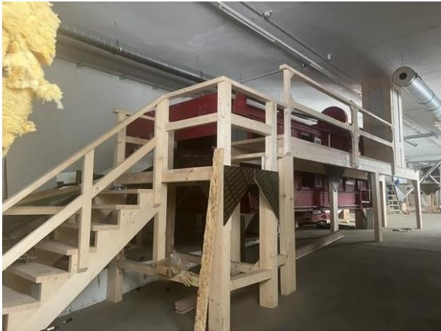
Windsichtung für Aussortierung Störstoffe und Wartungssteg für Zugriff und Wartung der tribo elektrischen Agglomerationseinheit. Hinten oben steht Feinstaub Filterhaus mit integralen Filterschläuchen.
