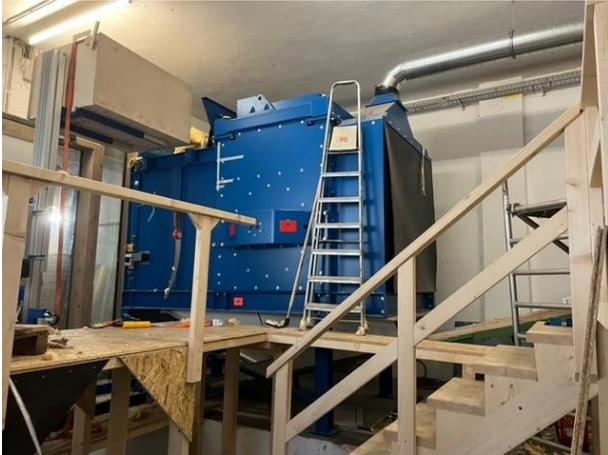
Aufnahme vom Vorreißer mit Befüll Aufzug hochgefahren zur Entleerung. Von oben rechts ist die Absaugung angeschlossen, welche direkt die bei Vorreisen entstehenden Stäube einfängt.
