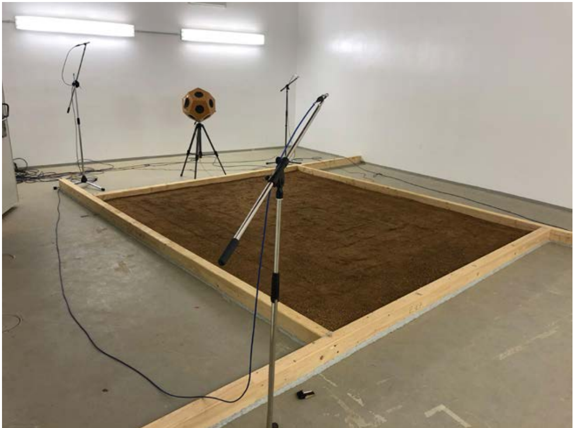
Abb. 69 Testreihe 4: partielle Austrocknung, Versuchsaufbau vor den Messungen. Foto Heiner Lippe
