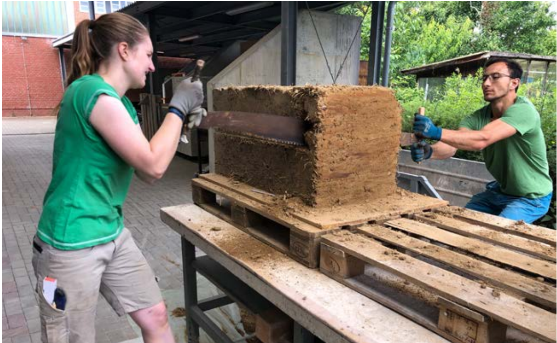
Abb. 62 Testreihe 1: Manuelles Trennen eines Wellerlehmblocks aus der Prignitz. Foto Heiner Lippe
