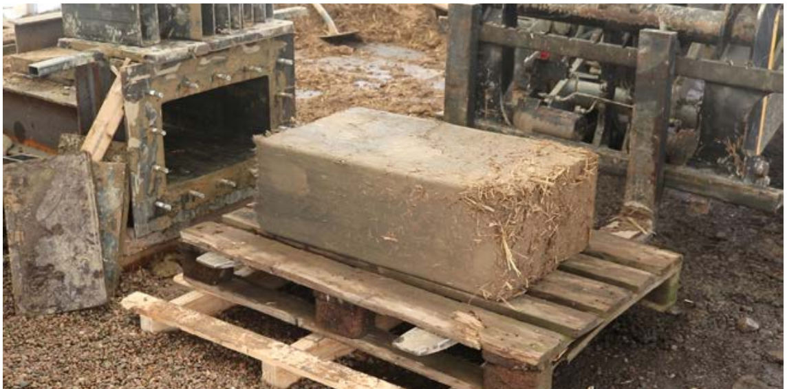
Abb. 32 Ein fertiger Wellerlehmblock im Maßstab 1:4 zu den geplanten Dimensionen. Die Ungleichmäßigkeit der Materialdichte – wie im Bild zu erkennen – soll in der Endanwendung durch wesentlich höheren Druck ausgeglichen werden. Videostill Ute Reeh
