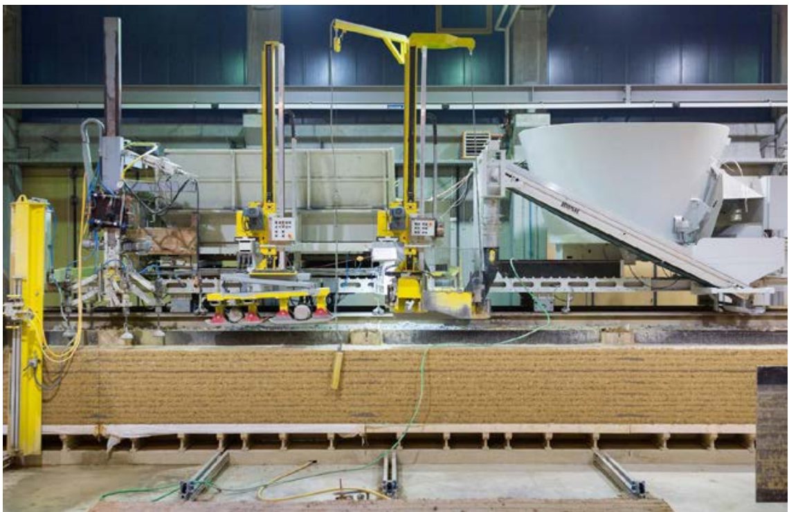
Abb. 17 „Roberta“ – Maschine zur Herstellung von vorgefertigten Stampflehmelementen; Foto Emmanuel Dorsaz / Lehm Ton Erde Baukunst GmbH
