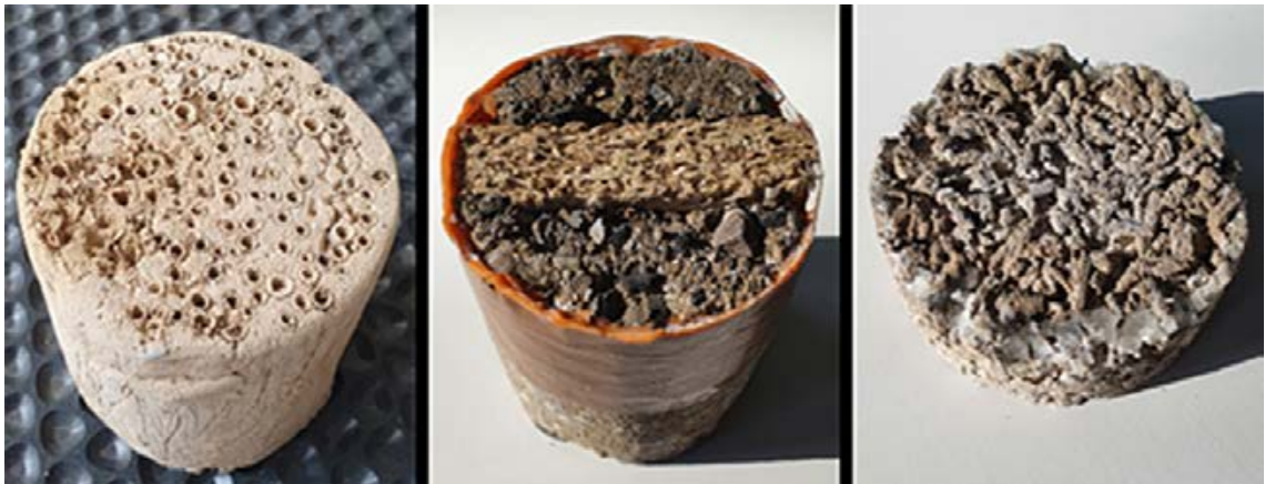
Abb. 75 Foto, das die vielversprechendsten Probekörper zeigt. Links der Lehmschlicker mit Schilfhalm, in der Mitte Stampflehm mit der HWL-Platte (Holzwolle/Magnesit) und rechts ein Stück des Hanfkalk-Probekörpers. Fotos BAST
