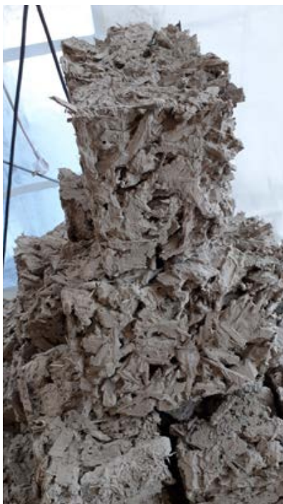
Abb. 70 Eine noch nicht vorerodierte Hackschnitzel-Lehm-Oberfläche. Foto Martin Rauch
