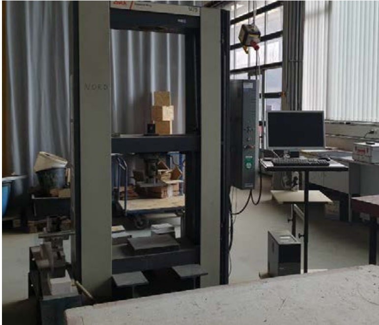
Abbildung 4: Presse zur Verdichtung der Lehmblöcke
