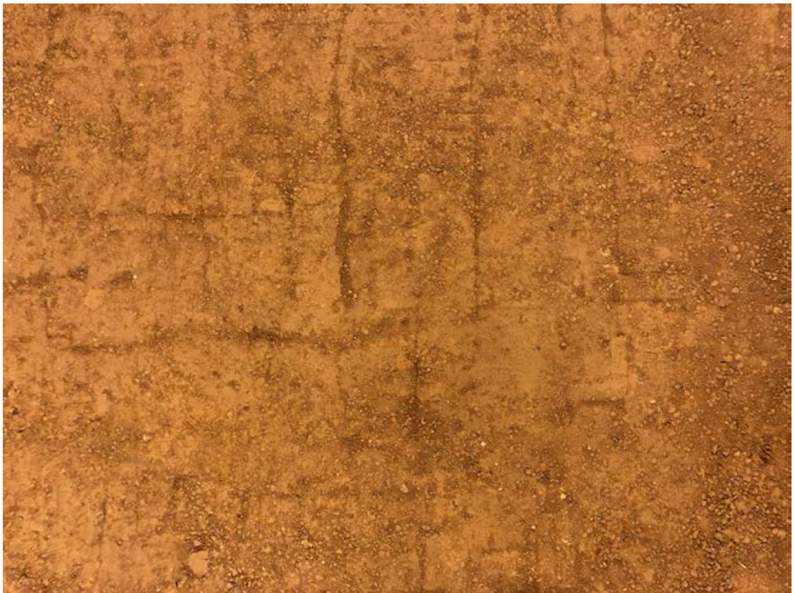
Abb. 67 Testreihe 3: Detailbild der Oberfläche des manuell gestampften Materials. Foto Heiner Lippe
