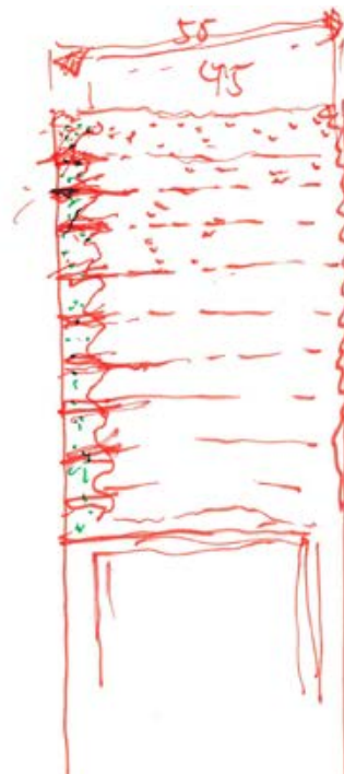
Abb. 71 Beispiel: Für die absorbierende(n) Seite(n) werden ca. 10 cm Holz-Hackschnitzel-Lehmgemisch zwischen Trasskalklagen eingestampft. Die Wände werden vorerodiert; übrig bleibt eine stark zerklüftete Oberfläche. Skizze Martin Rauch
