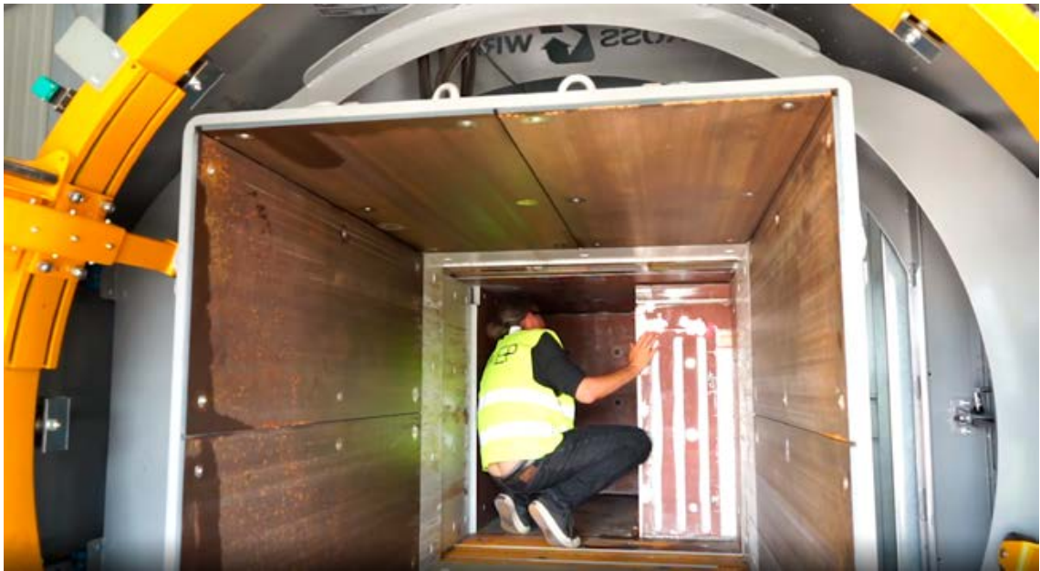
Abb. 30 Die "Presskammer", der Großpresse durch den Ausschubkanal gesehen (Videostill Ute Reeh)
