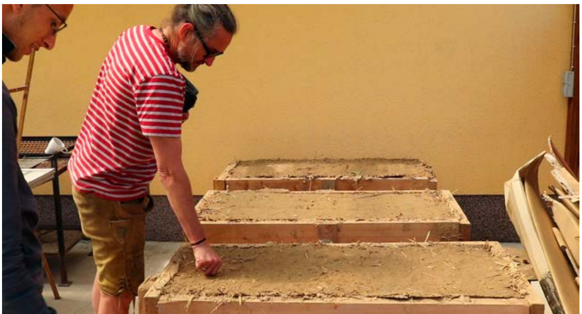
Abb. 26 Prof. Heiner Lippe prüft noch nicht ausgeschaltete Wellerlehmblöcke die im Rahmen des Baus der Probewand hergestellt worden und zwecks Akustikmessungen an der TH Lübeck vorgesehen sind. Foto Ute Reeh
