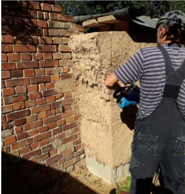
Abb. 27 Christian Hansel führt mit einer Motorsäge einen Sägetest von Wellerlehm durch. Foto Lehmbau Lovis UG
