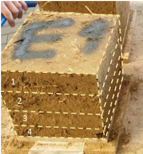
Abbildung 1: Lehmblock aus 4 Schichten
