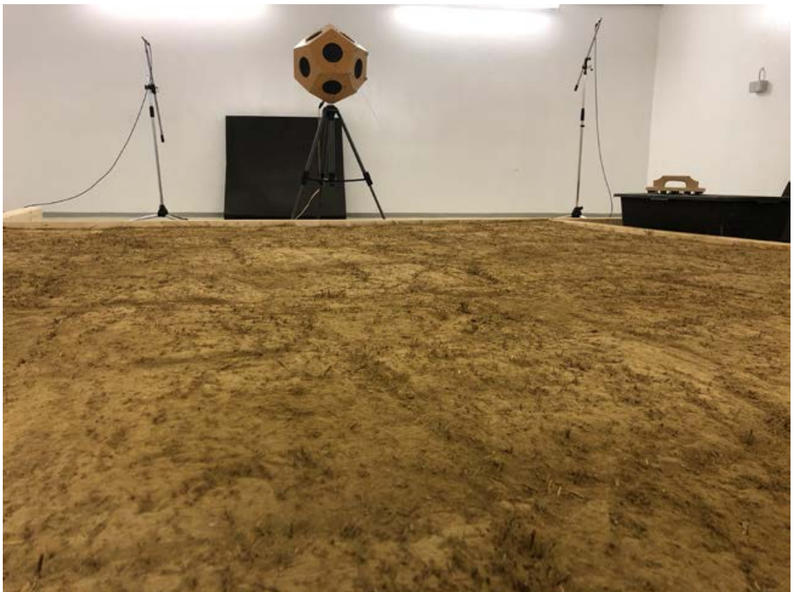
Abb. 65 Testreihe 2: Oberfläche der Testfläche nach Begradigung und Verfüllung. Foto Heiner Lippe
