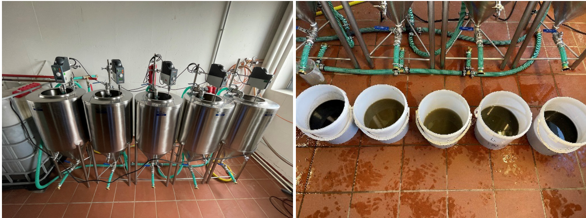
Abbildung 2-3: Absetzanlage mit Absetzreaktoren (links), Abgezogener Primärschlamm (rechts)
