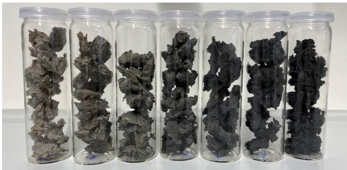
Abbildung 2-12: Getrockneter Primärschlamm; Kohlekonzentration ansteigend von links nach rechts (REF; Fe; P01-Fe; P025-Fe; P05-Fe; P10-Fe; P15-Fe)
