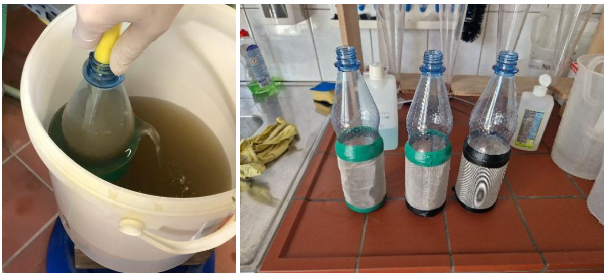
Abbildung 8-16: Links: Abwassersiebung; rechts Siebe mit unterschiedlicher Maschenweite
