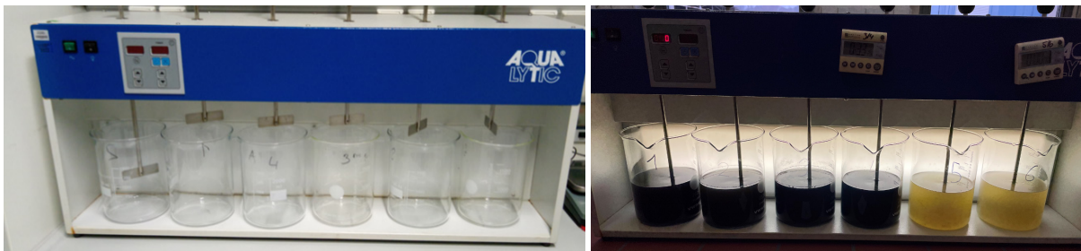
Abbildung 8-1: links: Reihenrührwerk ohne Proben; rechts Adsorptionsversuch mit Kohle und Referenz ohne Kohle
