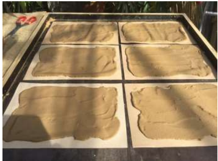
Abbildung 3: Versuchsreihe mit Trennschichten aus Papier und Lehmklebemörtel
