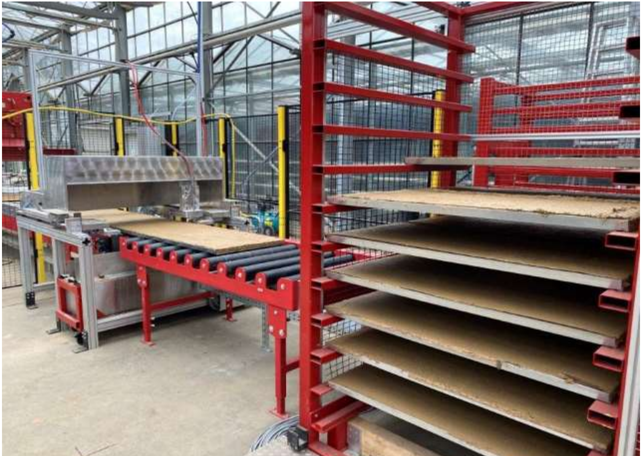
Abbildung 6: Prozessabschnitt von der Wasserstrahltrennung zur Wechselstellage
