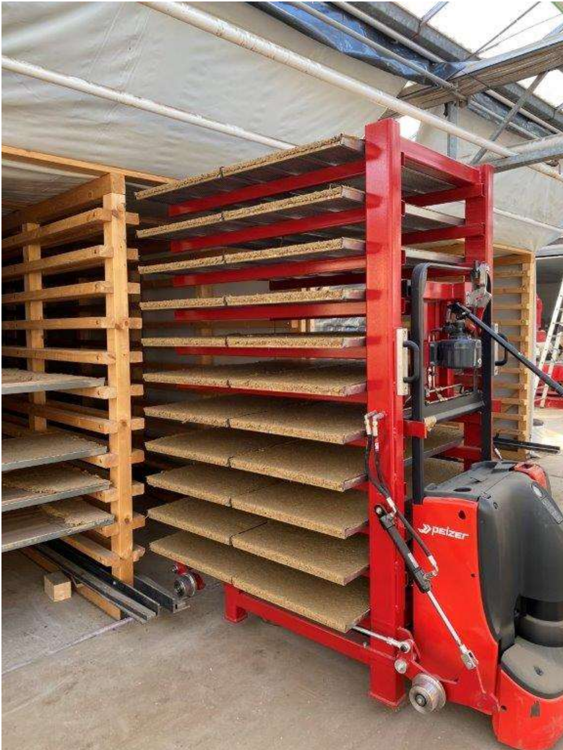
Abbildung 8: Einfuhr der Platten in die Trockenanlage
