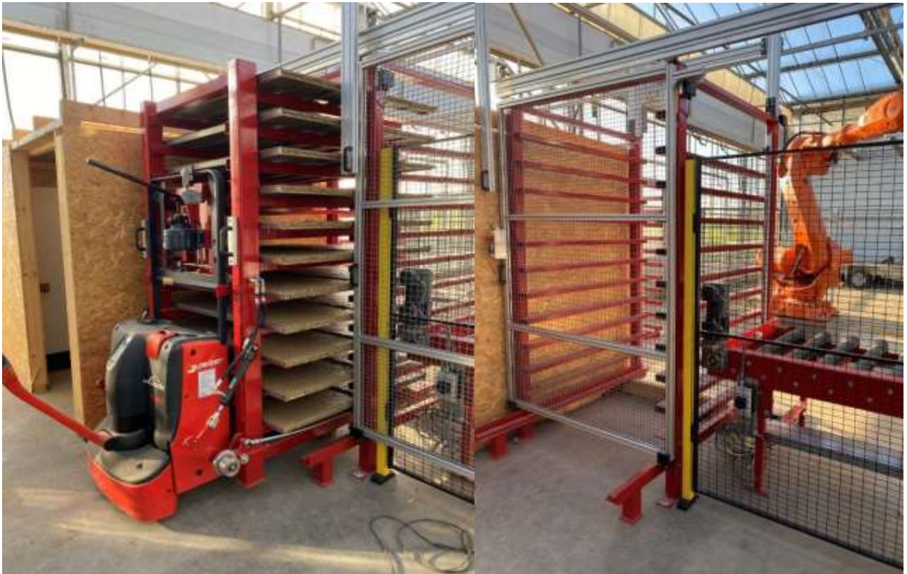
Abbildung 7: Übergabe vom Wechselgestell zum Transportgestell zur Trocknung
