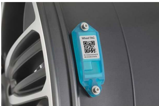
Abb. 1: Wheeltag-Sensor von ZF und Maxion Wheels im Bett einer Felge (Maxxion Wheels, 2021)
