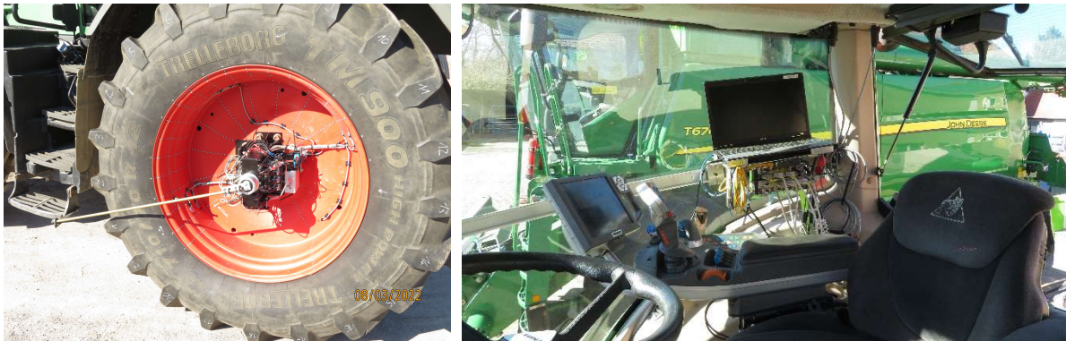
Abb. 9: links: Aufbau der Messtechnik im Rad am Traktor mit Drehmomentstütze des Winkelsensors, rechts Messtechnik in der Kabine
