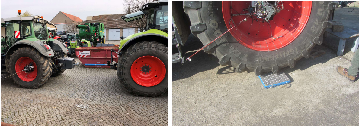
Abb. 10: links: Messtraktor mit Bremstraktor und Zugstange rechts: Radlastwaage im Einsatz
