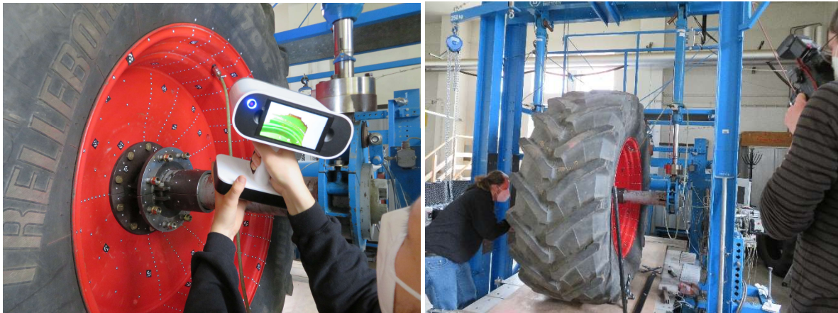
Abb. 14: Felge unter Last im Prüfstand beim Abscannen
