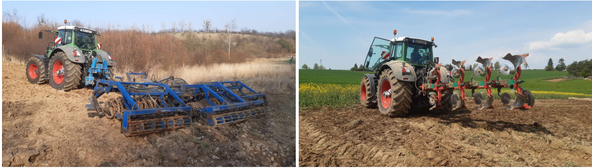
Abb. 33: Versuchstraktor mit Saatbettkombination (links) und Wendepflug (rechts)
