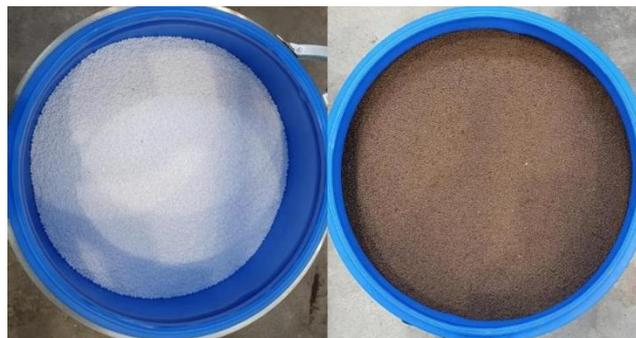
Abb. A17. Weltweit größte hergestellte Mengen Zellulose- und Ligninaerogel in 100l-Fässern (soweit bekannt).
