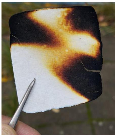
Abb. A3. Verpresste Aerogelpulverprobe nach orientierendem Brandtest.
