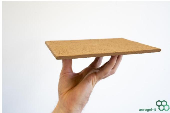
Abb. A2. Lignin-Aerogelplatte aus gepresstem Pulver.
