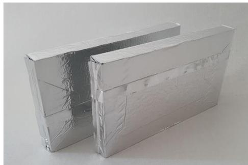
Abb. A12. VIPs auf Basis des Zelluloseaerogels.
