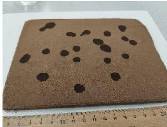
Abb. A7. Ligninaerogel mit Wassertropfen nach nicht erfolgreicher plasmagestützter Gasphasenhydrophobierung.
