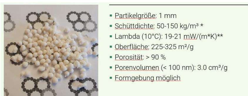
Abb. A9. Silica-Biopolymer-Hybridaerogelpartikel und zugehörige Eigenschaften (\*einstellbar; \*\* bei 10°C in der Schüttung).
