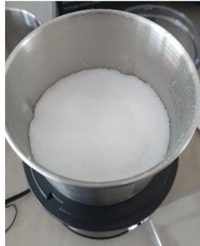
Abb. A11. Zelluloseaerogel-Pulver.
