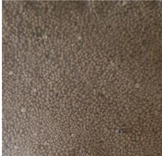
Abb. A4. Ligninaerogel mit Additiv.
