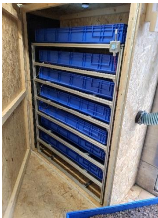
Abbildung 2: Klimakammer zur Aufzeichnung thermodynamischer Prozessgrößen. Der Versuchsstand erlaubt die Regelung der Eingangsgrößen (Temperatur, Luftfeuchtigkeit) und die Überwachung der Prozessgrößen (Substrattemperatur, Luftfeuchtigkeit- und Temperatur, CO 2 )
