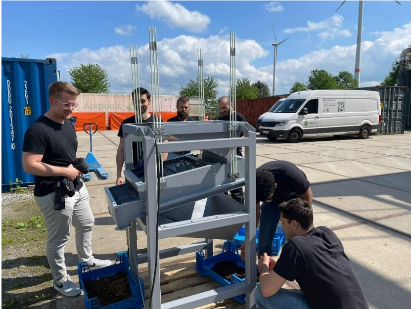
Abbildung 4: Testbetrieb eines Vibrationssiebs zur Separation der Larven von Larvenkot im Omnivore-Container (Eigenentwicklung)
