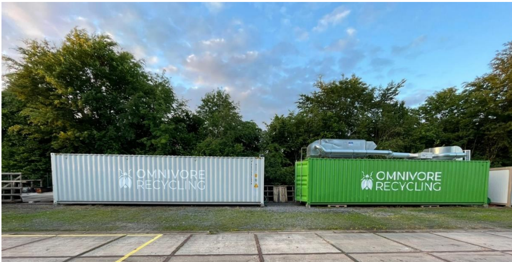
Abbildung 8: Omnivore-Container zur Mast und Ernte der Insektenlarven (grün) und Vorverarbeitungscontainer zum Entpacken, Zerkleinern und Vermischen der Lebensmittelreste. Das Substrat wird über eine Rohrleitung in die Mast gepumpt.
