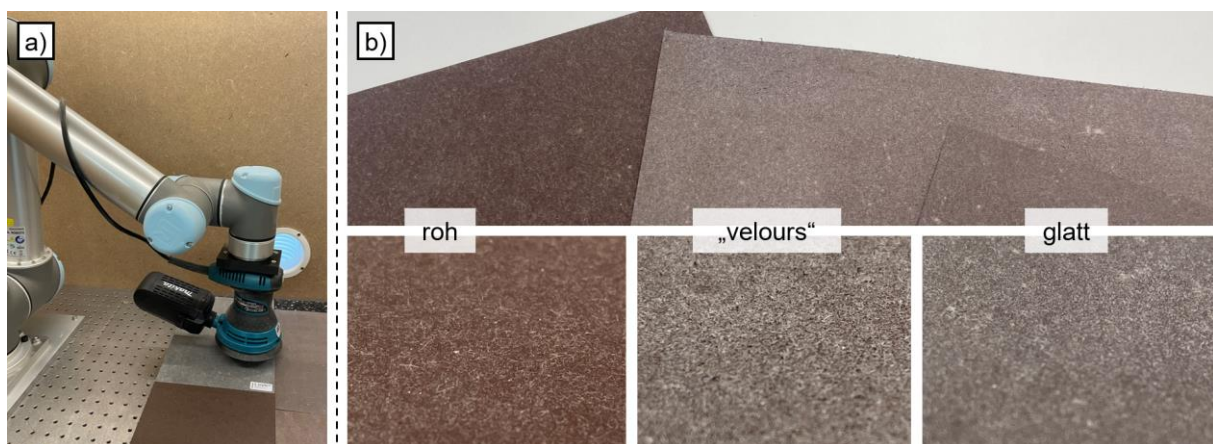
Abbildung 7: a) Schleifroboter für Laboranwendung, b) Unterschiedliche geschliffene Oberflächen von LOVR™.
